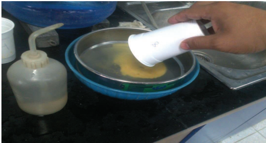
Figura 3.3. Lavado de la muestra y pasado por el Tamiz 230.
