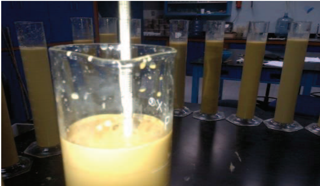
Figura 3.5. Hidrómetro para realizar lecturas de temperatura.
