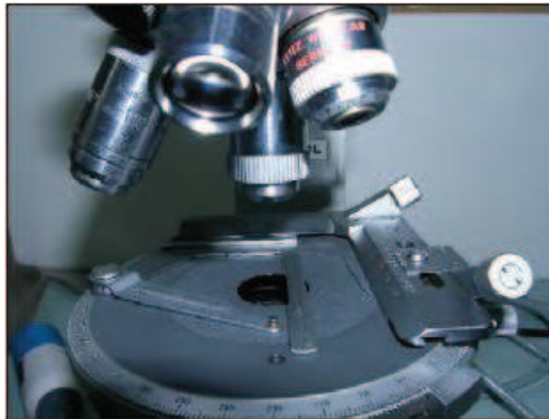
Figura 3.7. Microscopio usado en los estudios petrográficos, modelo Leitz Orthoplan, con platina graduable ajustable y graduada.
