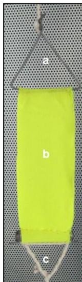
**Figura 16. Montaje con trozo de tela amarillo. (a)** Triángulo de alambre, **(b)** Trozo de tela amarillo 10 x 4 cm, **(c)** Trozo de metal.
