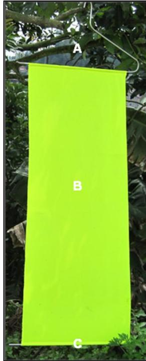
**Figura 48. Montaje preparado para el campo. A:** Gancho de metal, **B:** Trozo de tela amarillo 60 x 145 cm, **C:** Trozo de metal.
