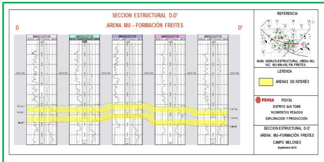
Figura V.10. Sección Estructural Horizontal D-D` arena MU
