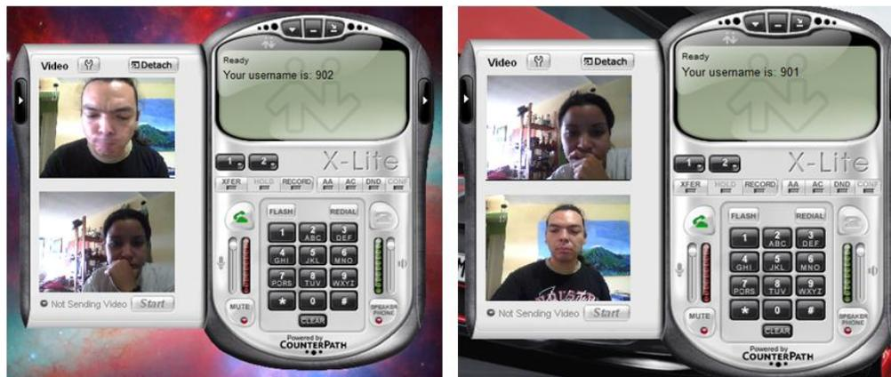
*Figura 4.1.- Prueba de Llamada Ambiente SIP-SIP a través de Elastix con softphone X-Lite.*
