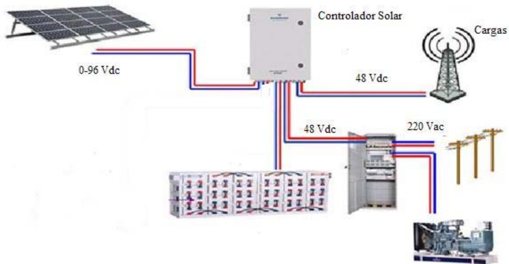
Figura 25. Diseño de un sistema de generación híbrido [25] (Solar-Motogenerador)
