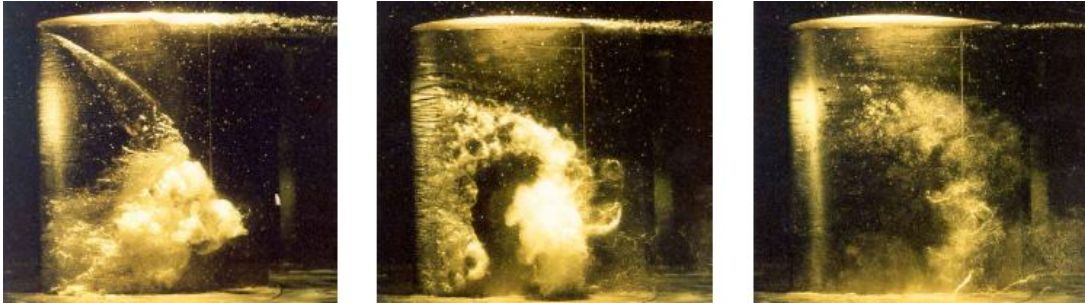
Figura 1.3. Formación, desprendimiento y colapso de una nube de cavitación. (Brennen, 1995).
