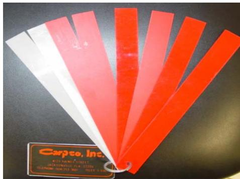
*Figura 4.8: Regletas de calibración del separador Magnet-Lift.*
