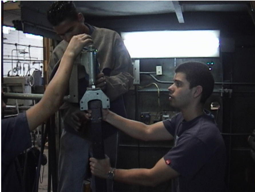
Montaje de la extensión de arco eléctrico al brazo
