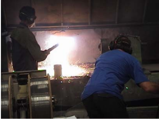
Probando el equipo de termorrociado
