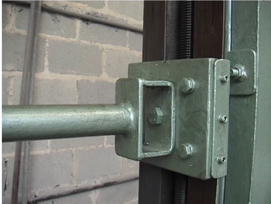
Unión del brazo de la pistola con la guía del husillo
