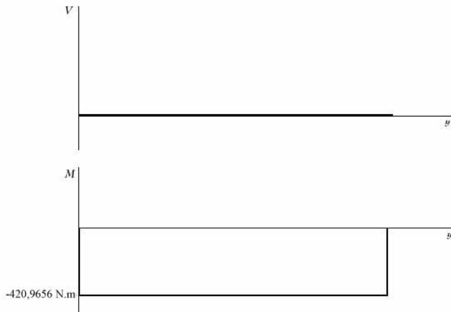
Figura 4.63.- Diagramas fuerza cortante y momento flector de la sección A-B
