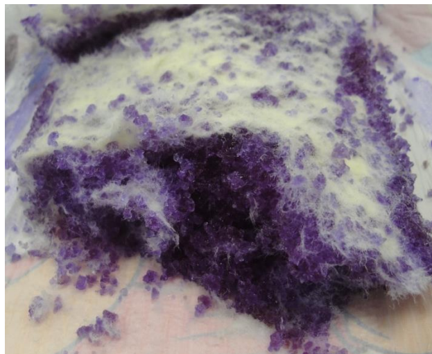
Fig. 40. Corte transversal del centro absorbente producto B1.
