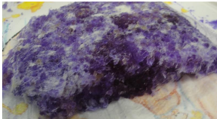
Fig. 46. Corte transversal del centro absorbente producto C1.
