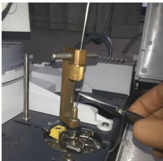
**Figura 15.** Introducción de la muestra sólida (capilar) en el inyector tipo Keele instalado en el puerto de inyección del CG-EM.
