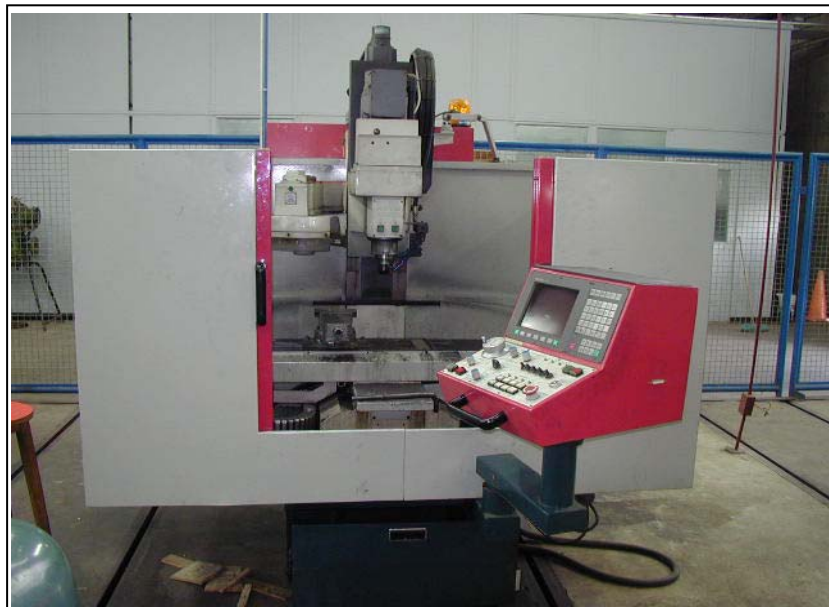
Figura N° 2.6. Centro de Mecanizado de la E.I.M.U.C.V. Tomado de los autores
