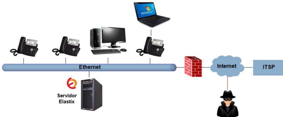
Figura 10.23: Ataque a una Red LAN con VoIP y una Conexión a un ITSP
