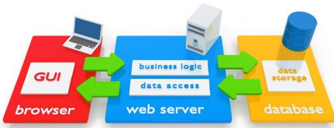
Figura 5 Estructura de Aplicaciones WEB
