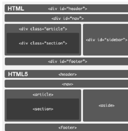
Figura 12 Estructura básica de una Aplicación Web tradicional y su equivalente en HTML5
