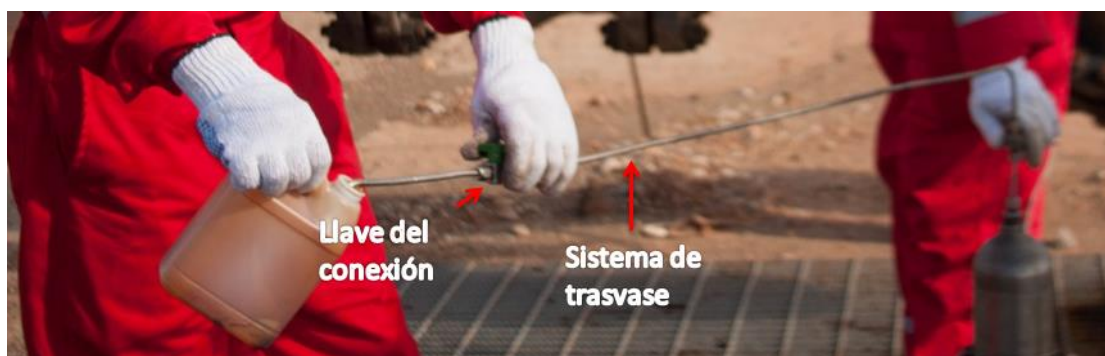
Figura 27. Llaves y conexiones en cabezal de pozo.
