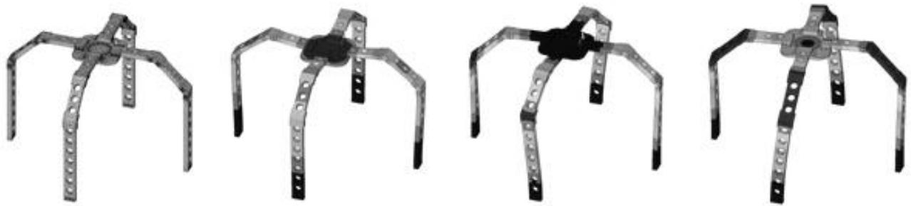
**Figura 3.** Mallado de la geometría y varios modos de vibración.
