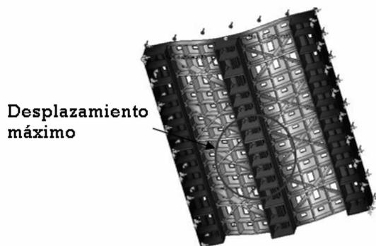
**Figure 7.** Desplazamiento máximo sufrido por la pieza bajo carga en modalidad túnel.
