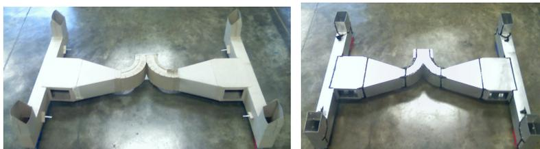
Figura 2 – Izquierda: Modelo (cartón 1 en kilo) escala 1:1. Derecha: Prototipo (aluminio)
