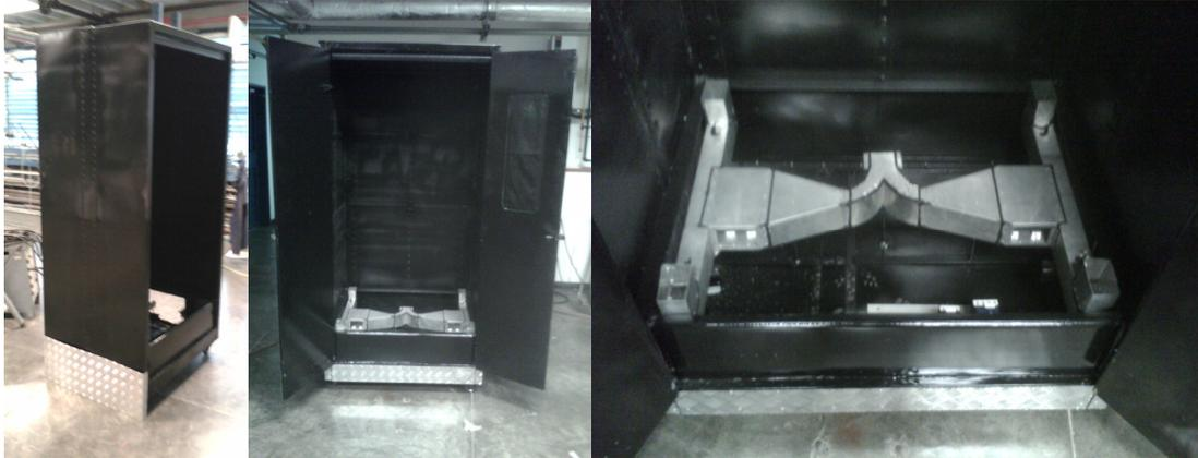
Figura 1 – Posicionamiento del distribuidor dentro de la unidad de secado bomberil. Izquierda: vista global. Derecha: detalle de instalación
