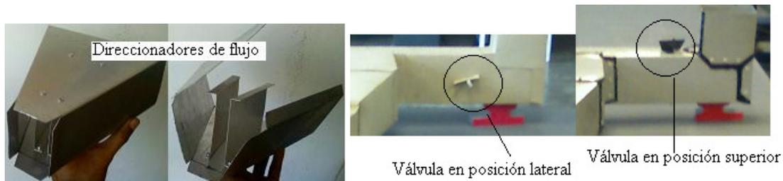
Figura 3 – Detalles constructivos determinados mediante el modelaje físico. Izquierda: direccionadores de flujo que sirven de refuerzo a la estructura. Derecha: cambio de posición de las válvulas cercanas a la descarga del distribuidor
