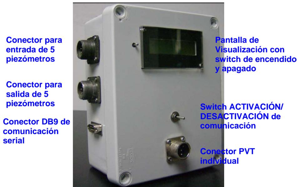
Figura 4- Vista Exterior del Prototipo.
