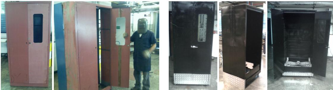
Figura 2 – Evolución constructiva de la unidad de secado bomberil, donde se evidencia el uso de material reciclado
