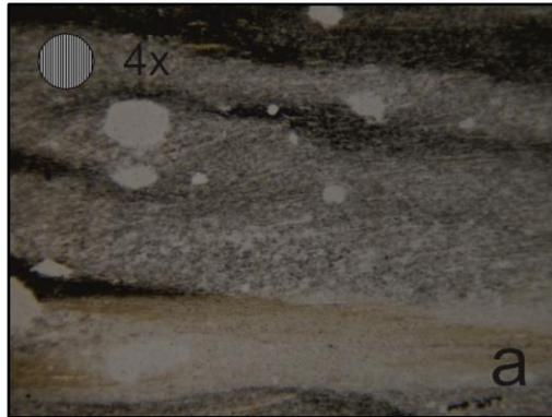
**Figura 18.** a) Muestra CA-017, filita grafitosa, se pueden observar zonas sin minerales debido a la pérdida de los mismos por acción meteórica.
