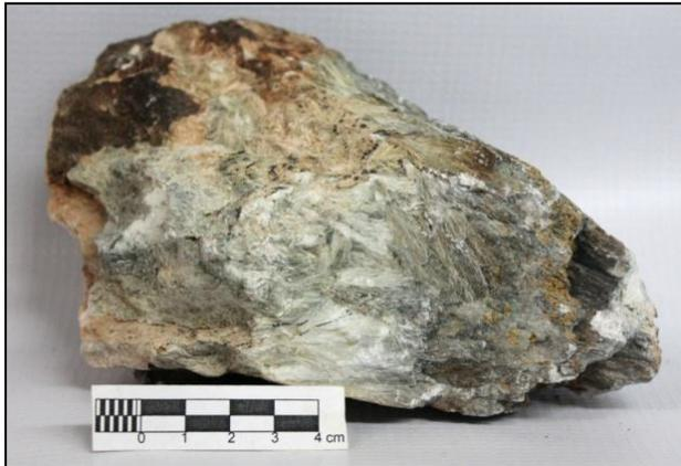
Fig. C5. Muestra Ya14-01B. Caracterizada por minerales aciculares de la serie tremolita-actinolita.
