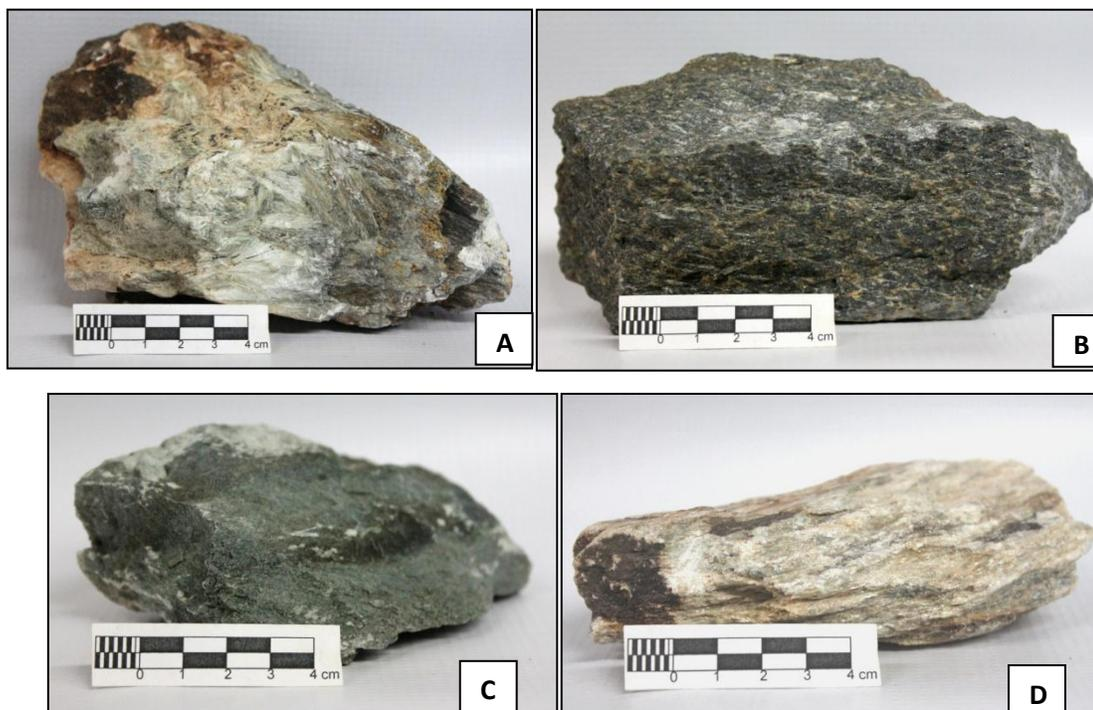
Figura 55. Peridotita Serpentinizada de Cabimba y Esquistos Verde de Agua Viva. Punto Ya14-01. A: Granofel actinolítico-talcoso, B: Mármol anfibólico, C: Esquistos verde, D: Esquistos talcoso (D).
