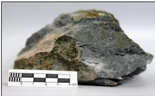
Fig. C73. Formación Agua Blancas. Po14-14. Caliza masiva con vetas de calcita. Muestra Co14-14.
