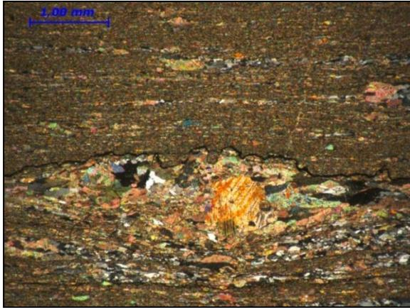
Fig. C18. Caliza foliada. Co14-02S. NC. Estilolitas. Reemplazo de sílice por calcita.
