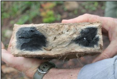
Fig. C85. Punto La14-17. Ladrillos de arcilla cocidos con los cuales se construyó la estructura de la iglesia.
