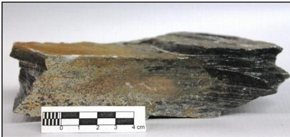
Fig.C62. Formación Agua Blancas. Muestra Po14-12. Caliza laminada con vetas de calcita.
