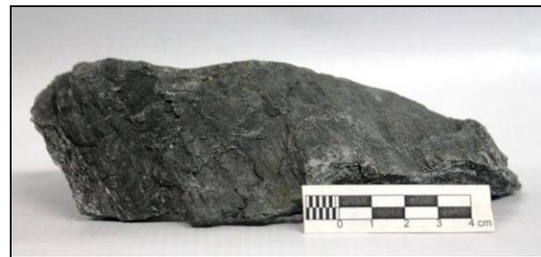
Fig. C38. Esquisto de Las Mercedes Mármol con alto contenido en materia orgánica. Vista en el cual se le aprecia el clivaje crenulado. Muestra Co14-08B.
