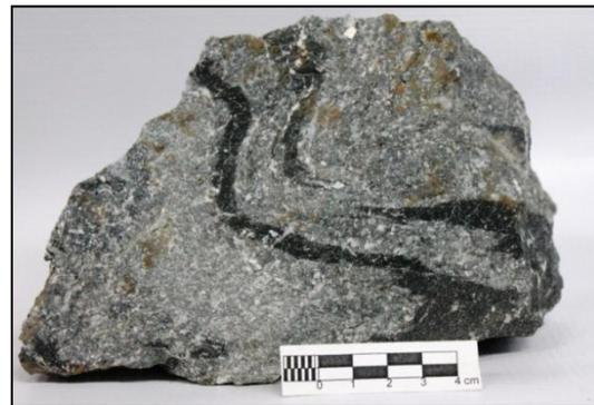
Fig.C56. Formación Cojedes. Arenisca carbonática Muestra Po14-11. Intercalación de arenisca con lodolita plegada.
