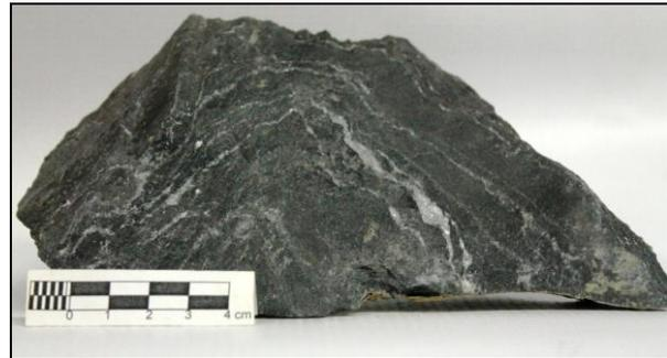
Fig. C37. Esquisto de Las Mercedes Co14-08B Mármol con alto contenido en materia orgánica. Vista en el cual se le aprecian las vetas de calcita plegadas. Muestra.
