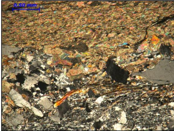
Fig.C57. Formación Cojedes. Arenisca carbonática Muestra Po14-11, NC. Contacto de lodolita con banda más siliciclástica. Micas orientadas
