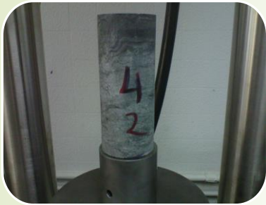
Probeta cilíndrica (4,7 cm)
