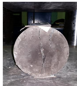
Figura 41. Falla de cilindro por tracción indirecta.
