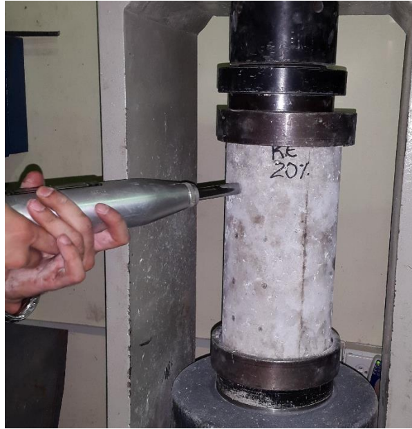
Figura 37. Ensayo esclerométrico para una mezcla del 20% de ripio a los 28 días
