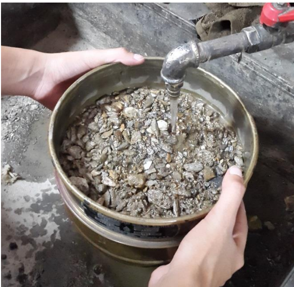
Figuras 7 y 8. Pasante #200 del agregado fino (arena lavada).
