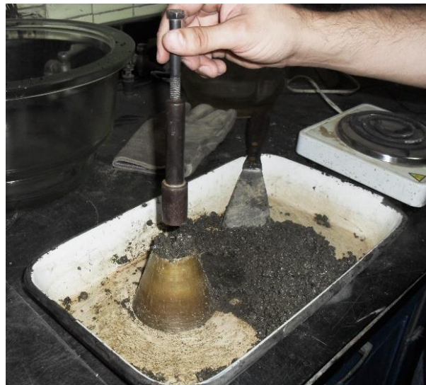
Figura 9. Agregado fino: arena lavada en molde; ensayo del cono para obtener una muestra saturada con superficie seca (SSS).
