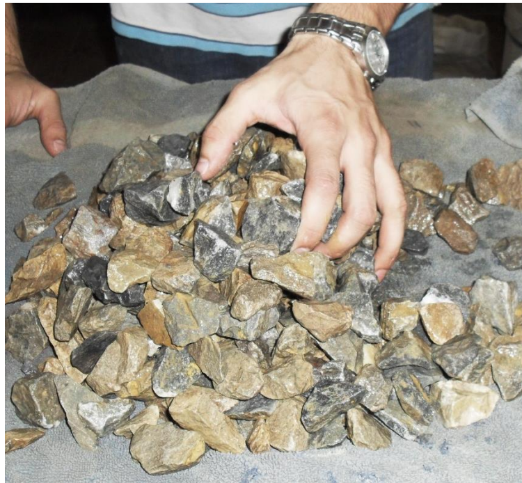
Figura 11. Muestra saturada con superficie seca en el aire.
