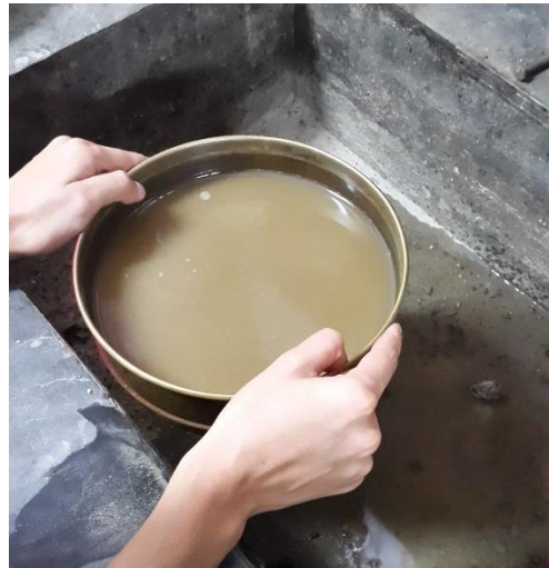
Figuras 7 y 8. Pasante #200 del agregado fino (arena lavada).
