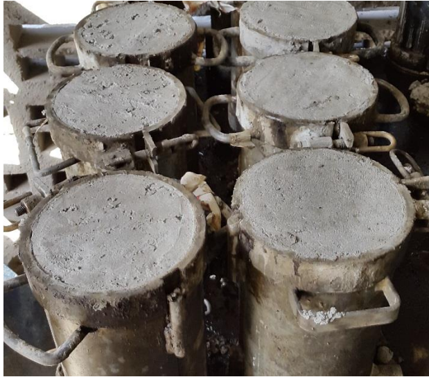
Figura 26. Enrasado de probetas. Fuente: Elaboración propia. Fecha: 20- Abril-2015.
