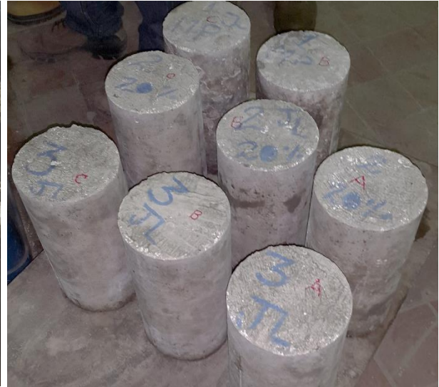
Figura 27. Probetas desencofradas. Fuente: Elaboración propia. Fecha: 21- Abril-2015.
