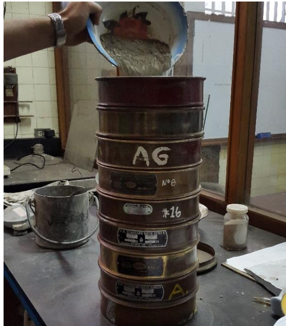
Figura 6. Tamizado manual del agregado fino por los cedazos \frac{3}{4} ", \frac{1}{2} ", \frac{3}{8} ", \frac{1}{4} ", #4, #8, #16, #30, #50 y #100.
