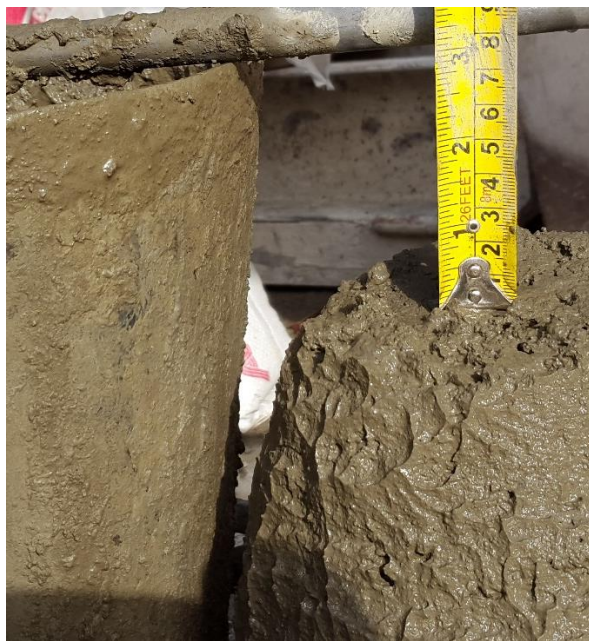
Figura 28. Medición del asentamiento.
