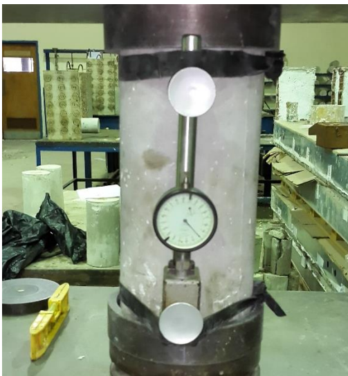
Figura 38. Extensómetro en una cara del cilindro.
