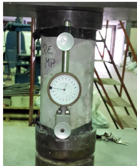
Figura 39. Extensómetro en cara posterior del cilindro.
