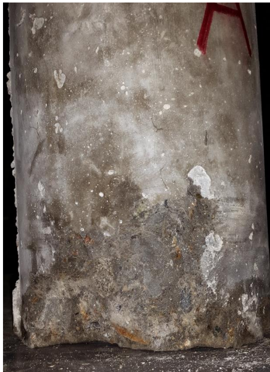
Figura 32. Falla de la probeta después de aplicarle la carga a los 28 días.
