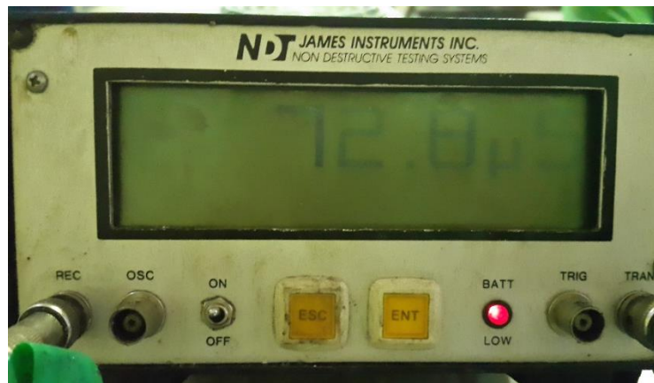
Figura 36 Velocidad del pulso ultrasónico medido en \mu\text{s} (microsegundos) en mezcla patrón.
