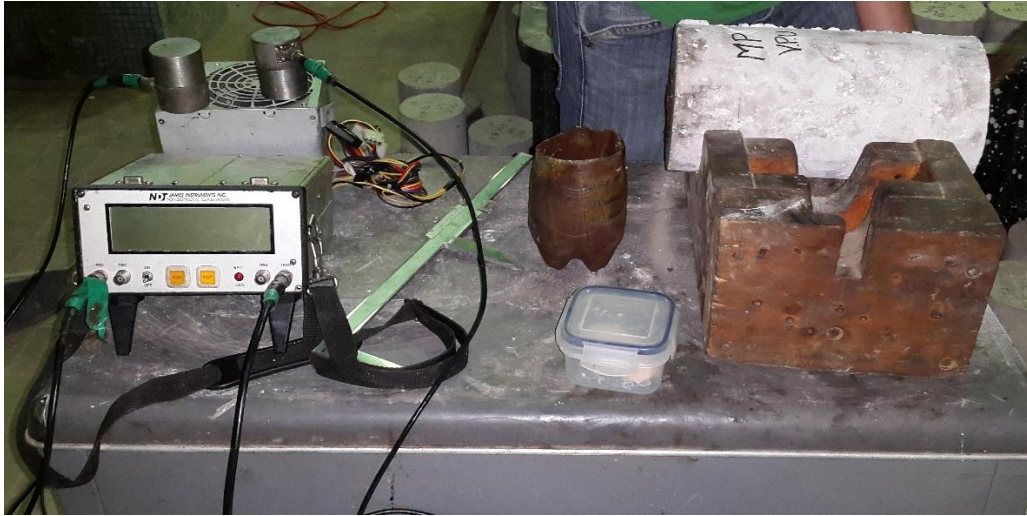
Figura 35. Ensayo de velocidad de pulso ultrasónico a los 28 días.
