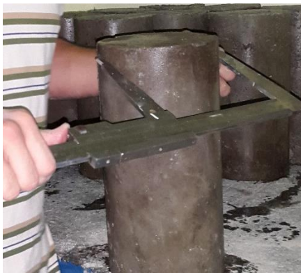
Figura 29. Medición del diámetro de la probeta con vernier. Fuente: Elaboración propia. Fecha: 27-Abril-2015.
