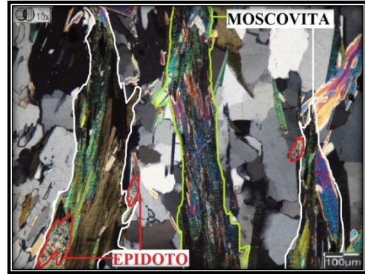
Figura 5.14. Bandas lepidoblásticas de micas que definen la foliación
