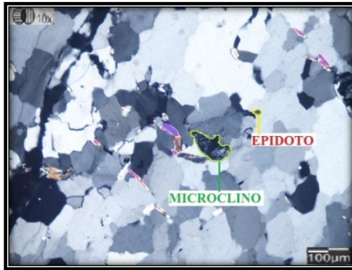
Figura.5.1. Se denota el alto contenido de cuarzo en toda la sección fina.
