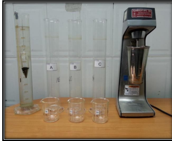
Figura 2.13 Equipo para realizar ensayo de hidrómetro. Agitador eléctrico con vaso modelo H-4260
