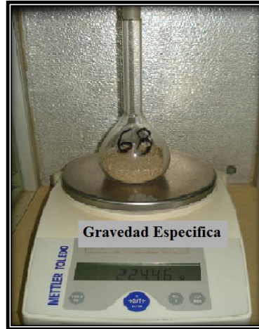
Figura 2.9. Picnómetro 250 ml, Boro 3,3. Balanza digital marca Setra
