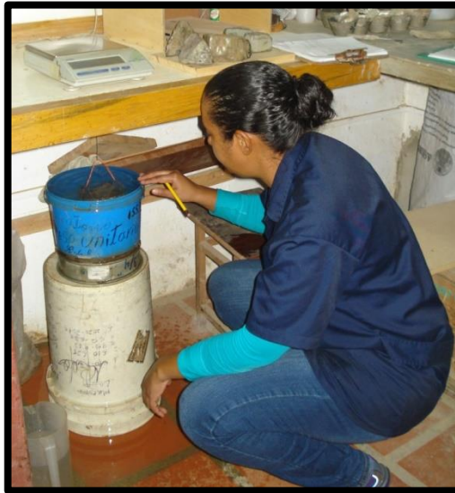
Figura 2.19 Proceso para realizar peso unitario con parafina en roca.
