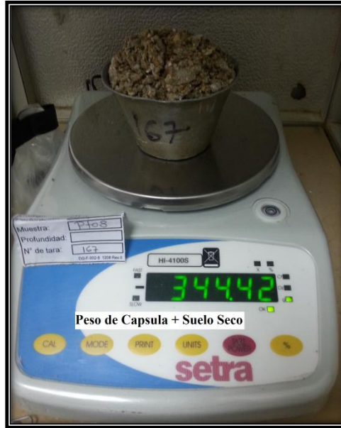
Figura 2.14 Balanza digital con error de 0,01 mg, utilizada en el ensayo de humedad, marca Setra.
