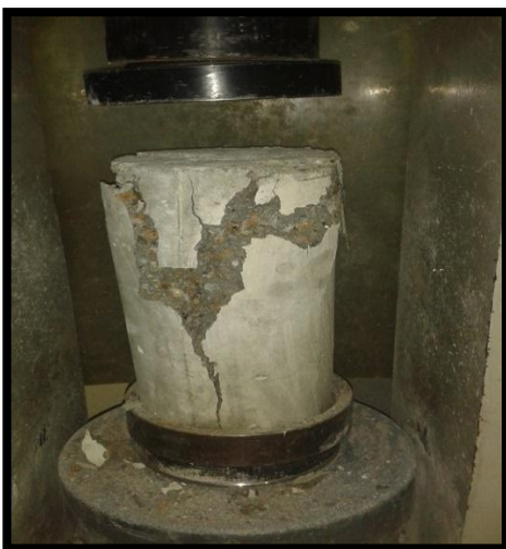
Falla de Tipo N°: 3 (Anexo 7)
