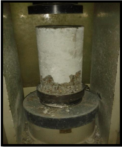
Falla de Tipo N°: 2 (Anexo 7)
