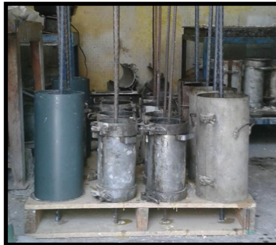
Figura 3.27 Colocación de los moldes en la base de madera.
