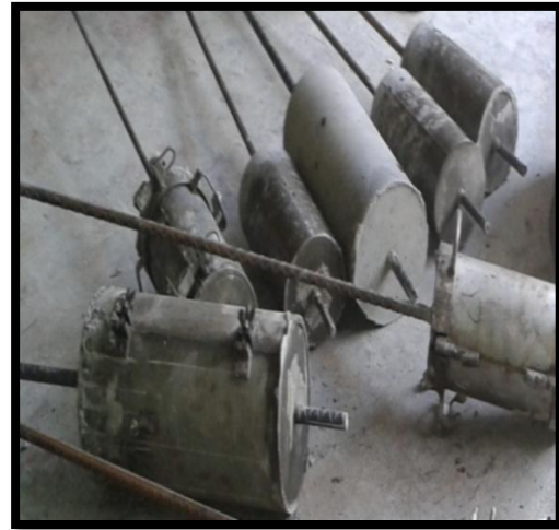
Figura 3.30 Desencofrado de las probetas.
