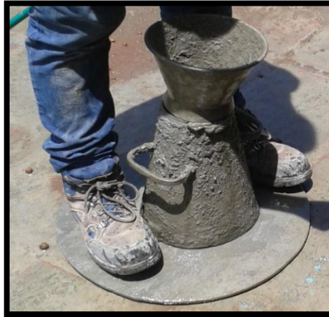
Figura 3.8 Colocación del cono de Abrams.
