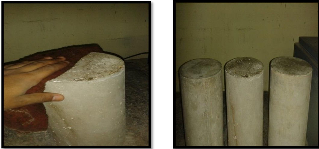
Figura 3.19 Limpieza y secado de la superficie lisa de las probetas.
