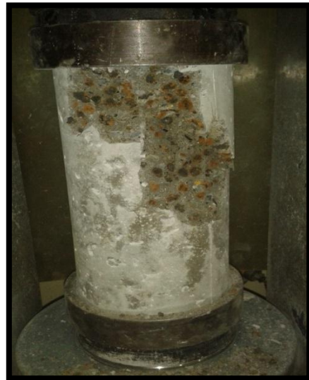
Falla de Tipo N°: 5 (Anexo 7) Edad de Ensayo: 14 días Mezcla: Numero 2
