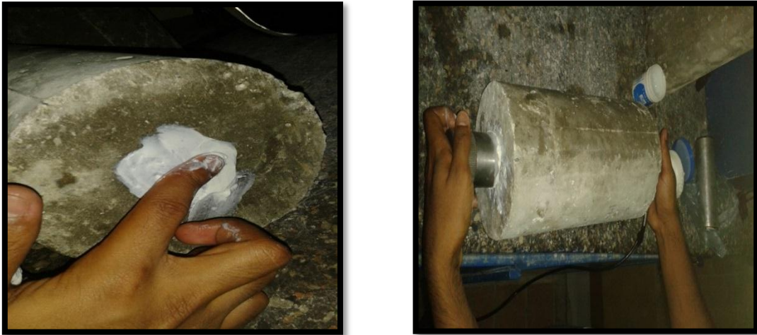
Figura 3.21 Colocación de vaselina y acoplamiento entre el transductor y el concreto.
