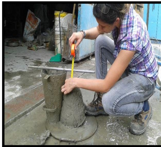
Figura 3.11 Medición del asentamiento.
