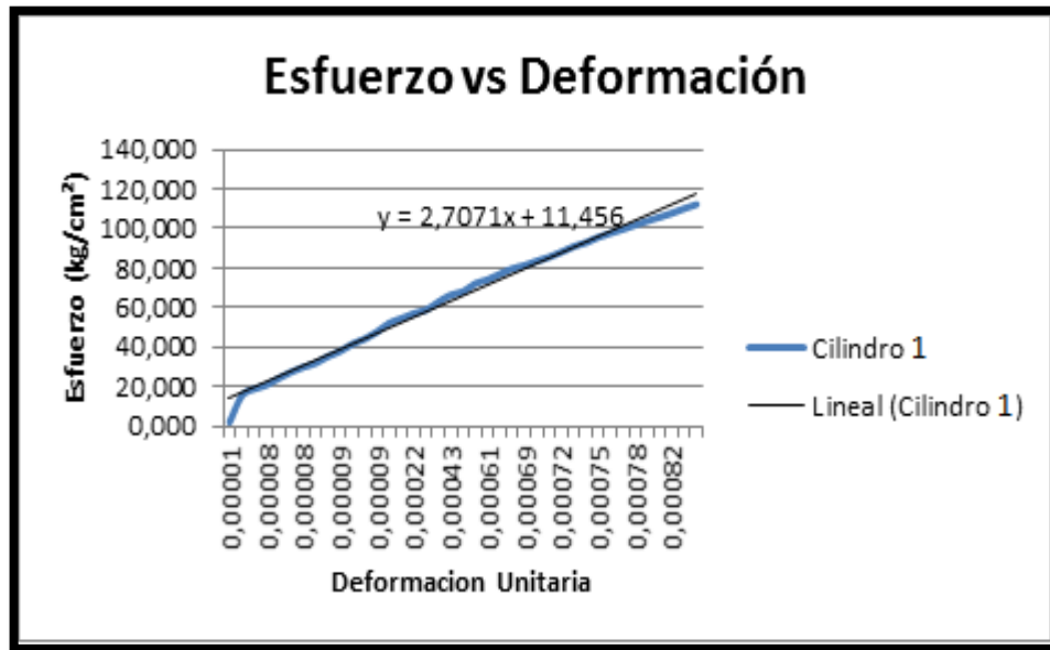
Gráfico 4. 26 Esfuerzo-deformación unitaria cilindro 1 (mezcla 3)
