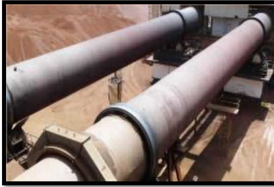
Figura 2. 8 Hornos rotatorios de agregado liviano. Fuente: Folleto Agregados Livianos C.A (2012).
