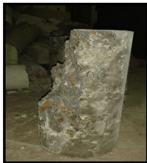
Falla de Tipo N°: 2 (Anexo 7) Edad de Ensayo: 28 días Mezcla: Numero 3
