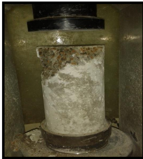
Falla de Tipo N°: 2 (Anexo 7) Edad de Ensayo: 7 días Mezcla: Numero 1
