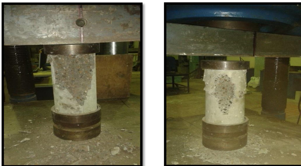
Figura 3.18 Falla de los cilindros.
