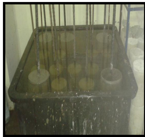
Figura 3. 31 Colocación de las probetas en la piscina de curado.
