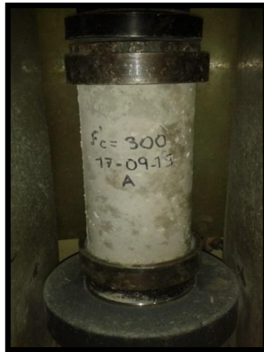
Figura 3.14 Colocación de la probeta en la prensa.
