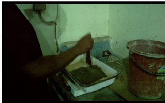
Figura 3.3 Secado de la muestra con una estufa.
