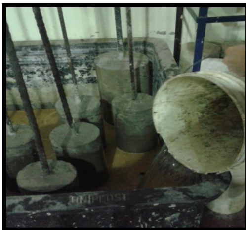
Figura 3. 31 Colocación de las probetas en la piscina de curado.
