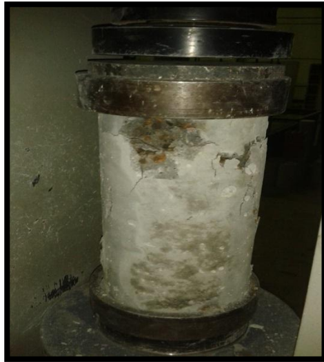
Falla de Tipo N°: 5 (Anexo 7)
