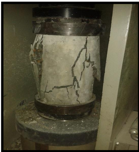
Falla de Tipo N°: 3 (Anexo 7) Edad de Ensayo: 28 días Mezcla: Numero 2
