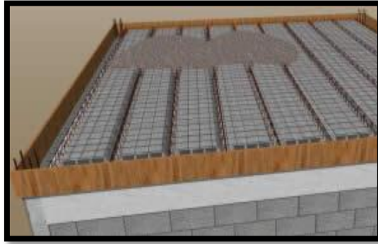
Figura 2.12 Vaciado de una losa nervada con bloques ALIVEN. Fuente: Folleto Agregados Livianos C.A (2012).
