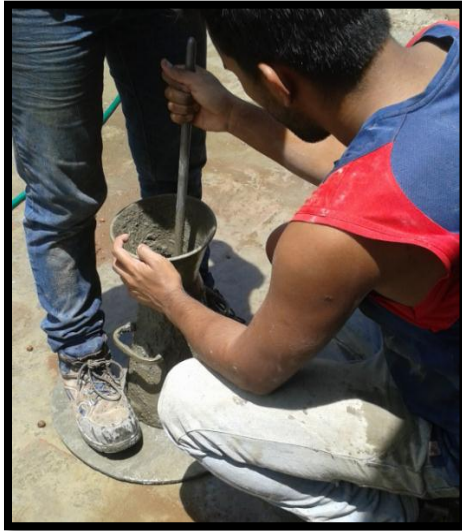
Figura 3.10 Compactación en el cono de Abrams.
