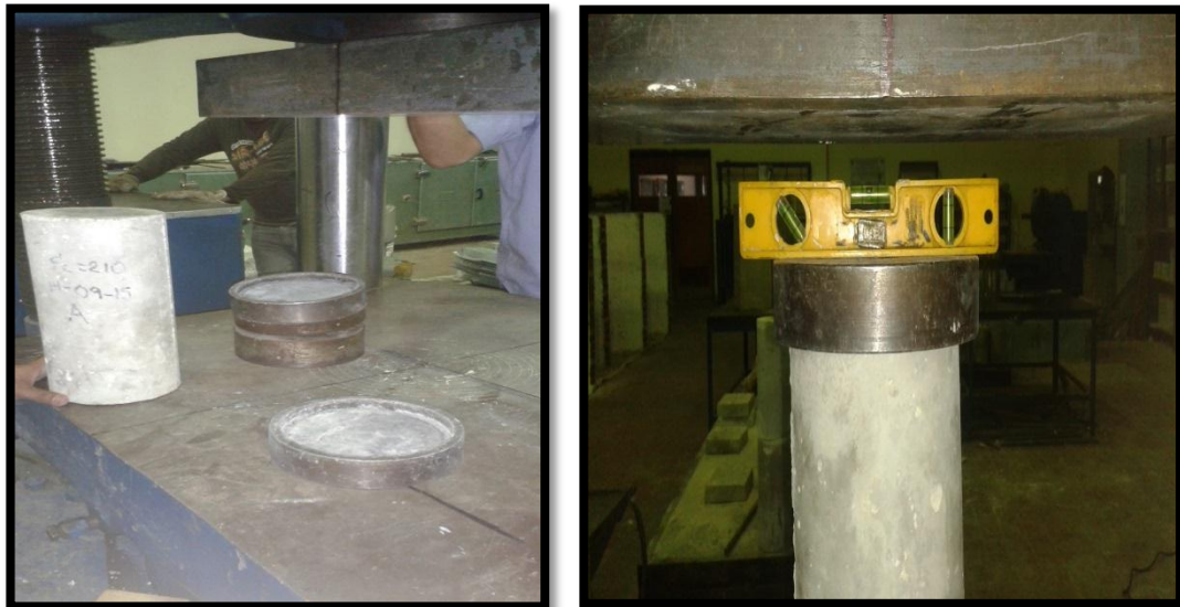
Figura 3.16 Colocación y nivelación de la probeta.
