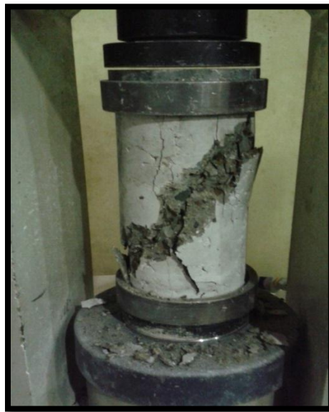
Figura 3.15 Falla del cilindro.
