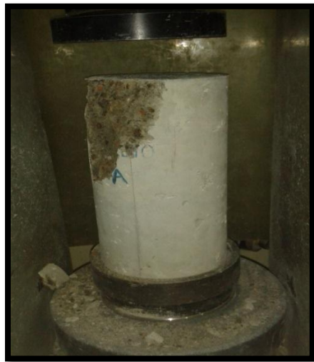
Falla de Tipo N°: 5 (Anexo 7)
