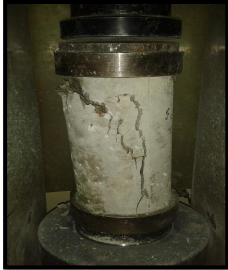
Falla de Tipo N°: 4 (Anexo 7) Edad de Ensayo: 14 días Mezcla: Numero 3
