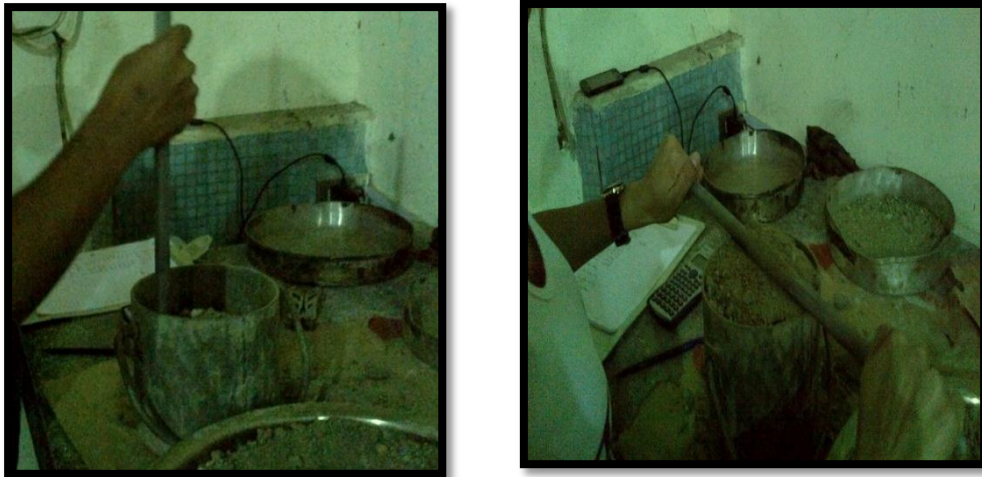
Figura 3.7 Compactación de la muestra.
