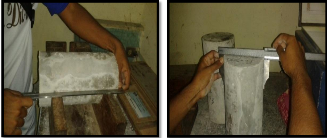
Figura 3.12 Medición del diámetro y altura de la probeta.
