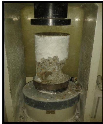
Falla de Tipo N°: 2 (Anexo 7) Edad de Ensayo: 28 días Mezcla: Numero 2
