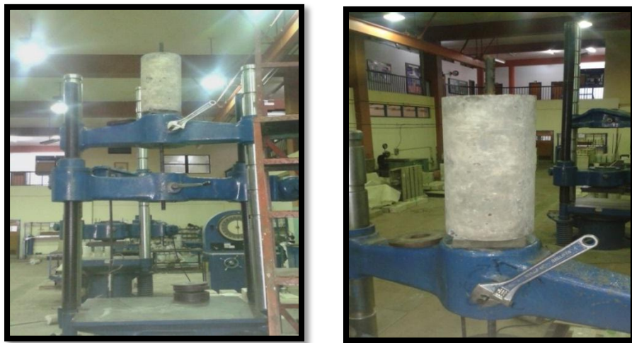
Figura 3. 32 Cilindro en contacto con la plataforma.
