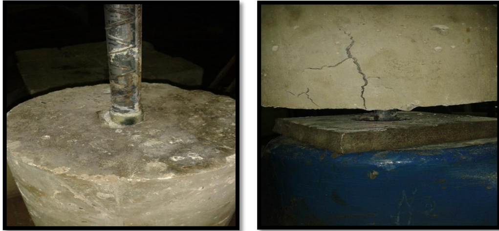
Figura 3. 35 Deslizamiento de las barras en el concreto.
