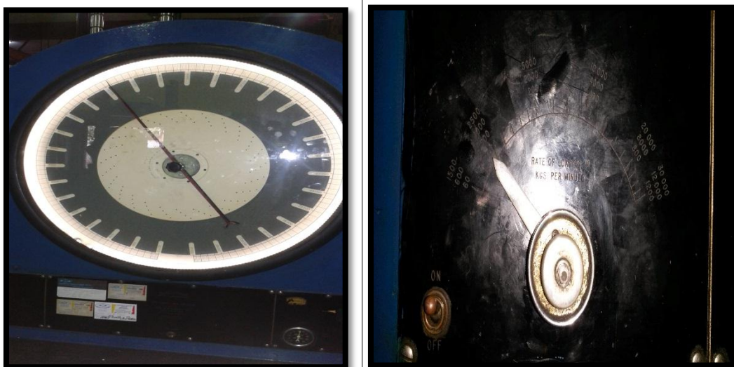
Figura 3. 34 Aplicación de carga a una velocidad de 2.250 kg/minuto.
