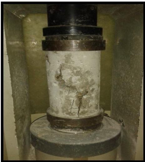
Falla de Tipo N°: 5 (Anexo 7)
