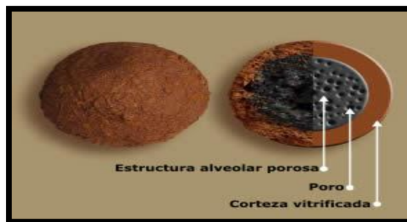
Figura 2. 9 Pellas de ALIVEN. Fuente: Folleto Agregados Livianos C.A (2012).
