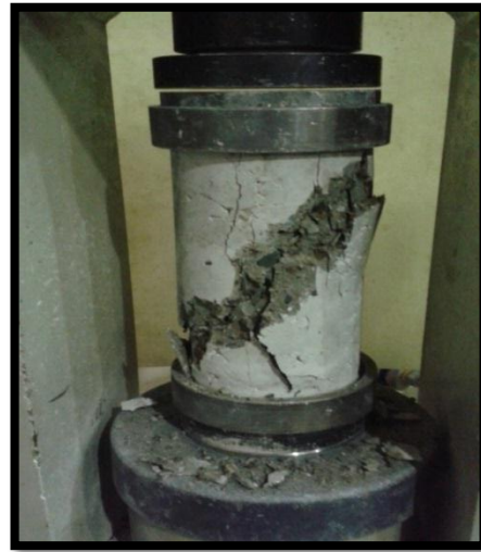
Falla de Tipo N°: 4 (Anexo 7)
