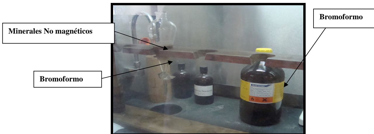
Figura 28. Procedimiento para la separación de minerales pesados y livianos.
