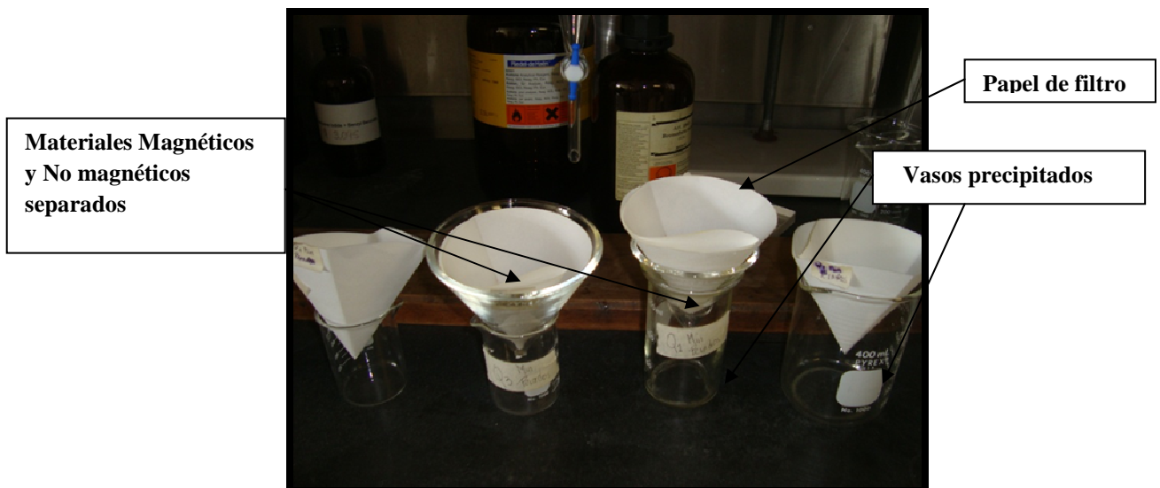
Figura 29. Fracciones pesadas y no pesadas obtenidas durante el proceso de separación por Bromoformo.
