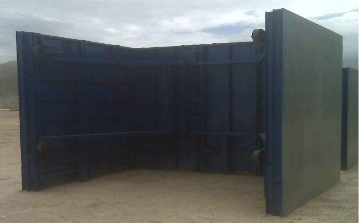
Figura II. 5: Vista encofrado tipo túnel, Fuente Sparthaco Haack
