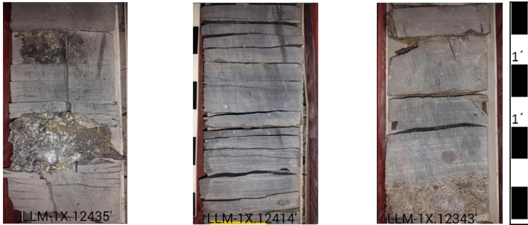
Figura 44. Núcleo BOR-8. Lutita calcárea (12435'), lutita friable (12414'), limolita calcárea (Wackestone de foraminíferos 12343').
