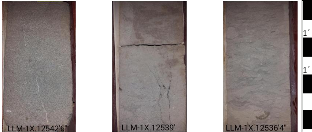
Figura 29. Núcleo LLM-1X. Dolomía arenosa de grano medio (12.542'6''), dolomía arenosa de grano fino (Dolomía calcítica aloquímica arenosa de arena fina, 12.539'') y arenisca calcárea de grano fino (12.536'4'').
