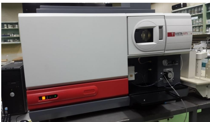
Figura 22. Equipo para la determinación de elementos minoritarios, marca Varian modelo VISTA-MPX .
