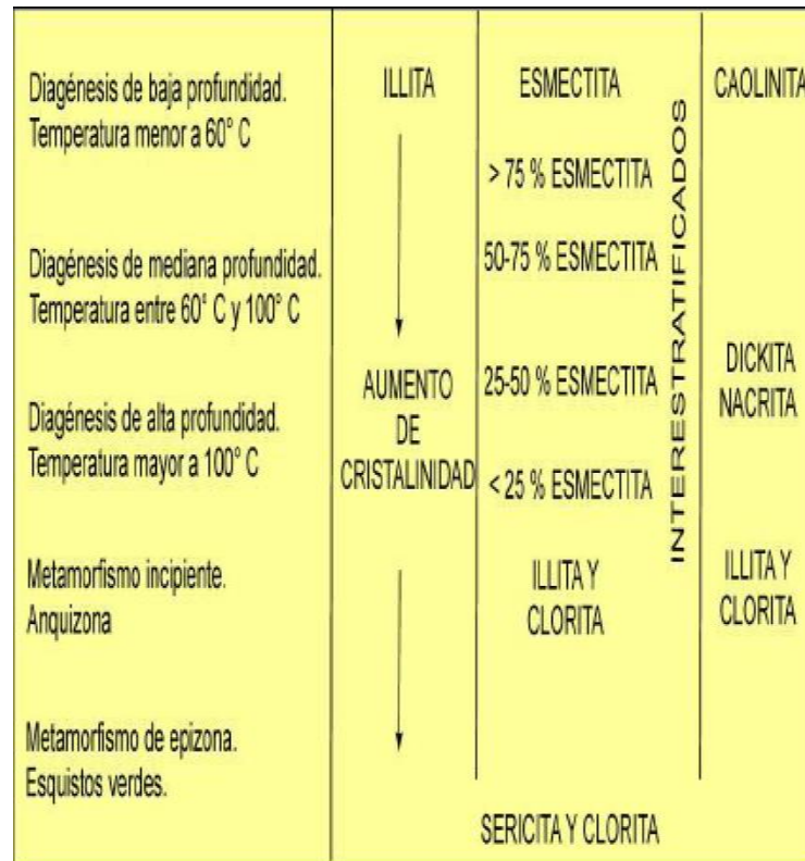
Figura 63. Estadios diagenéticos y % de capas de Illita en los interestratificados (I/S).
