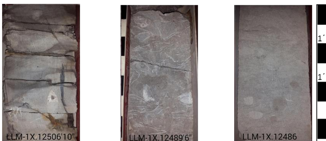
Figura 35. Caliza arenosa de grano fino (Caliza aloquímica arenosa de arena media, 12.506'10''), Caliza fosilífera (Packstone de bivalvos, 12.489'6''), Arenisca calcárea (Arenisca calcidolomítica aloquímica muy fina, 12.486').
