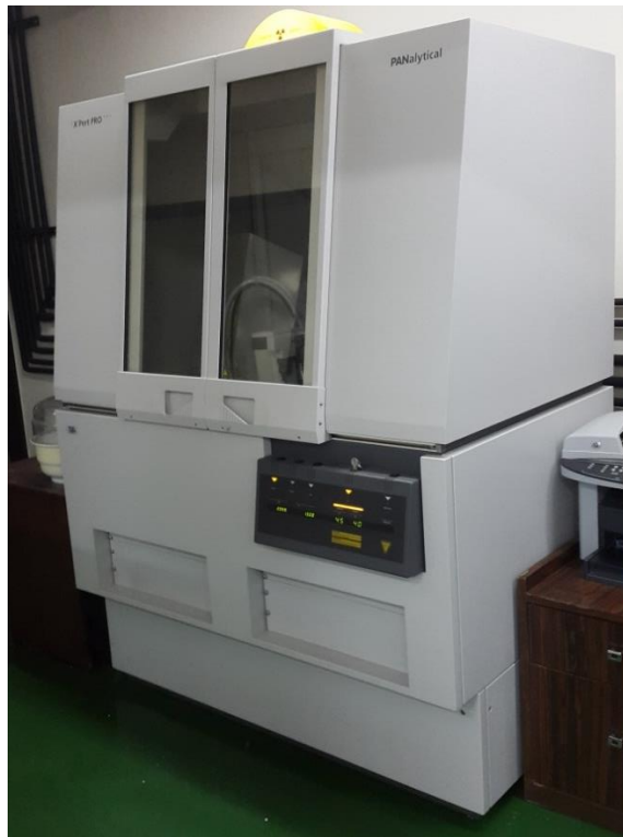
Figura 21. Equipo para la realización de la difracción de rayos X, Marca PANALYTICAL modelo X PERT PRO.
