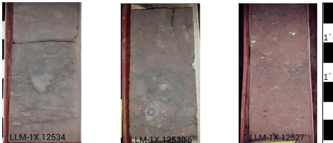
Figura 30. Núcleo LLM-1X. Arenisca de grano fino (12.534'), Caliza fosilífera (packstone de ooides12.530'6'') y Caliza fosilífera (packstone de ooides, 12527').
