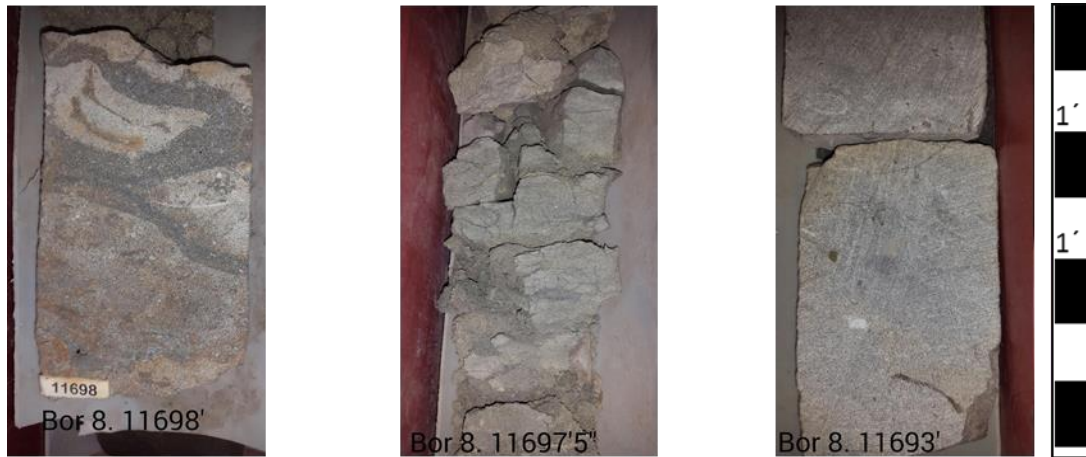
Figura 38. Núcleo BOR-8. Arenisca calcárea de grano medio (11.698'), Arenisca glauconítica sueltade grano medio (11.697'5'') y Dolomía arenosa (Dolomía aloquímica arenosa de grano fino 11.693').
