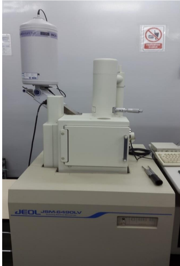
Figura 24. Equipo para la realización de la microscopía Marca OXFORD INSTRUMENTS, modelo INCAPenta FETx3 7573.
