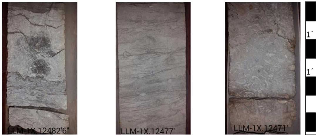
Figura 36. Caliza fosilífera (Packstone de bivalvos 12.482'6''), Arenisca (Arenisca dolomítica aloquímica de grano fino, 12.477') y Caliza fosilífera (Packstone de ooides, 12.471').
