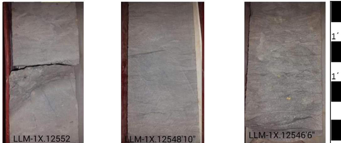
Figura 28. Pozo LLM-1X Dolomía arenosa bioturbada de grano grueso (Dolomía aloquímica arenosa de arena gruesa 12.552'), dolomía arenosa de grano fino (Dolomía aloquímica arenosa de arena fina 12.548'10'') y dolomía arenosa de grano grueso (12.542'6'').
