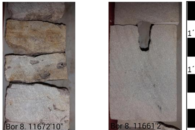
Figura 40. Dolomía (Carbonato cristalino de dolomita 11,672'10''), Dolomía arenosa (Dolomía aloquímica arenosa de grano muy fino 11.661'2'').
