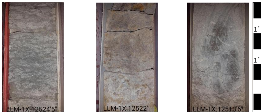
Figura 34. Arenisca de grano fino (12.524'5''), Dolomía (Carbonato cristalino de dolomita, 12.522') y Caliza fosilífera (packstone de ooides, 12.513'6'').
