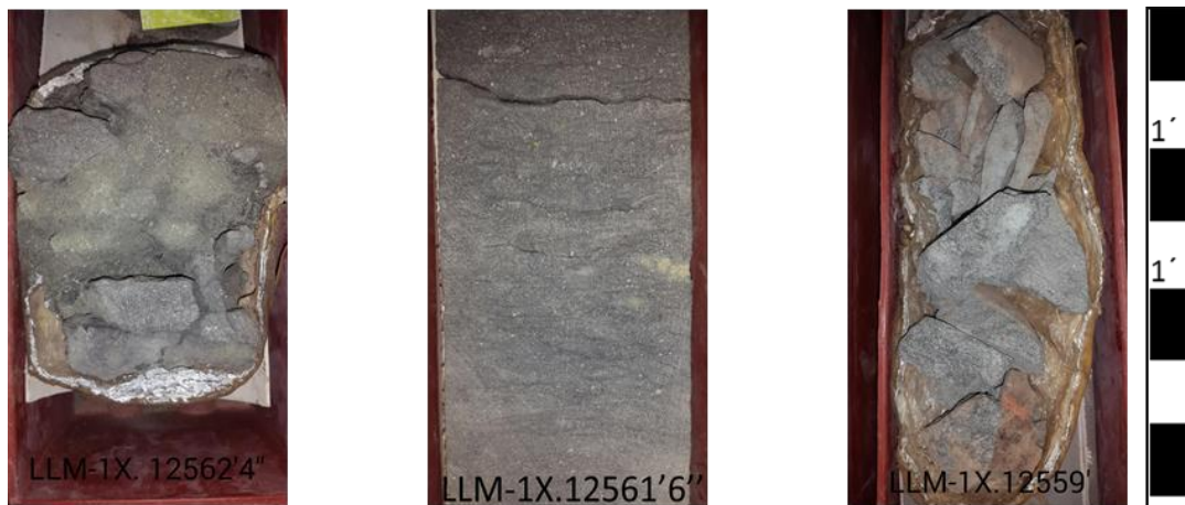
Figura 27. Núcleo LLM-1X. Obsérvese arenisca glauconítica de grano muy fino (12.562'4''), arenisca bioturbada (Arenisca aloquímica de arena gruesa 12.561'6'') y arenisca glauconítica de grano grueso (12.559').
