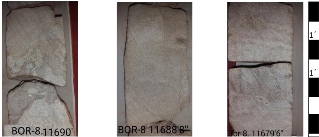
Figura 39. Dolomía arenosa (Dolomía aloquímica arenosa de grano fino 11.690'') Dolomía arenosa (Dolomía aloquímica arenosa de grano fino 11.688'8'') y Dolomía arenosa (Dolomía aloquímica arenosa de grano medio 11.679'6'').
