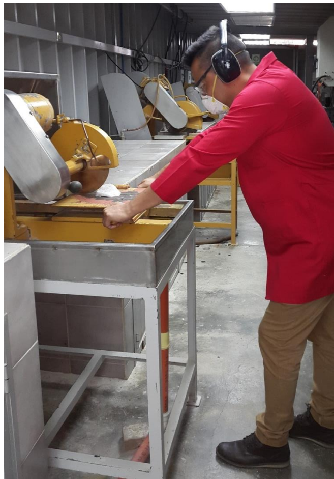
Figura 18. Fotografía del técnico de la nucleoteca cortando la roca para generar los tacos de las secciones finas.
