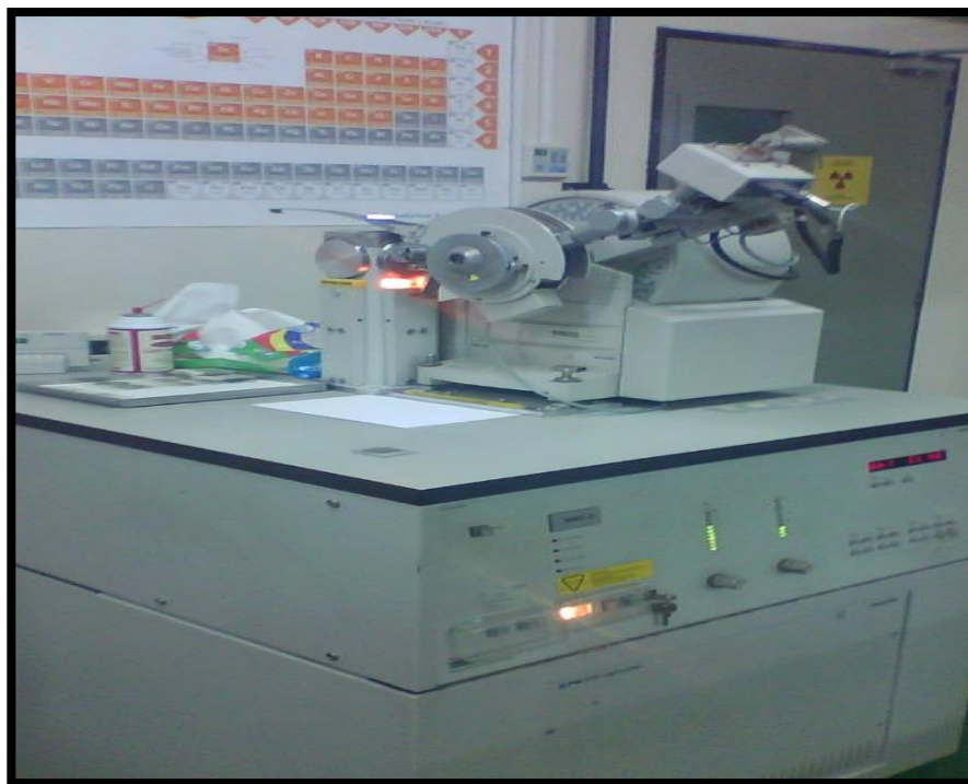
Figura 27. Difractómetro marca Philips utilizado en el análisis de las muestras.
