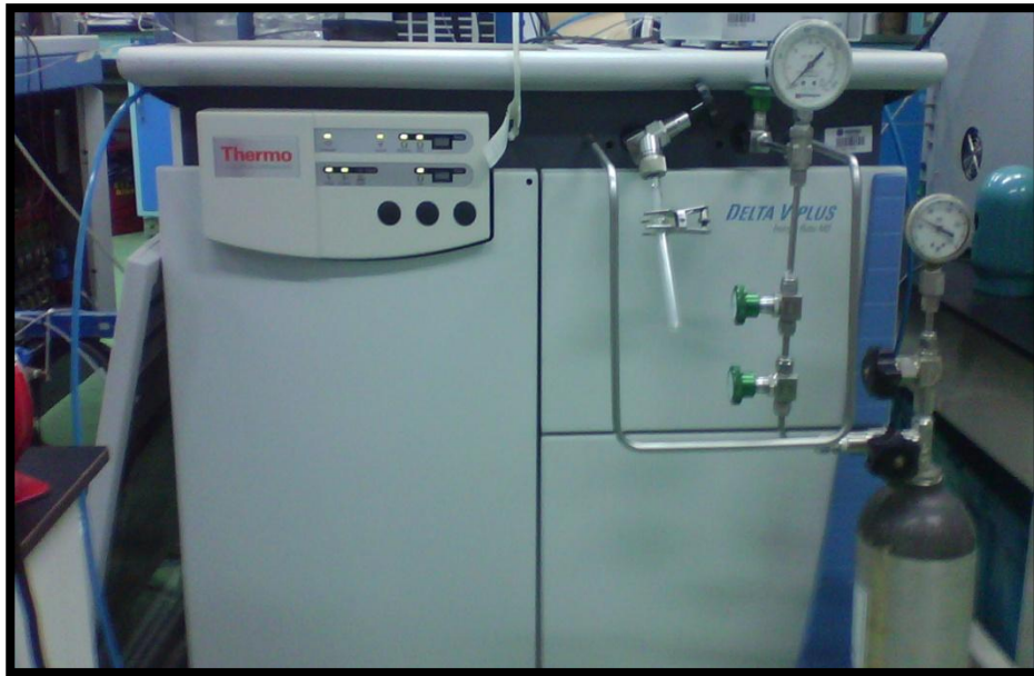
Figura 26. Espectrómetro de masas THERMO DELTA V PLUS, en el cual se realizaron los análisis isotópicos.
