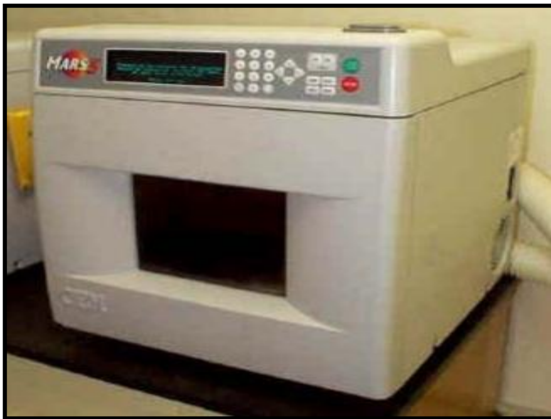
Figura 24. Equipo de microondas MARS5 utilizado para la digestión total de las muestras.
