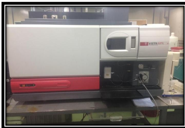
Figura 32. ICP-OES marca Varian, modelo Vista-MPX CCD simultaneos.
