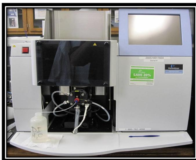
Figura 28. EAA marca Perkin Elmer modelo Precisely AAAnalyst 200.
