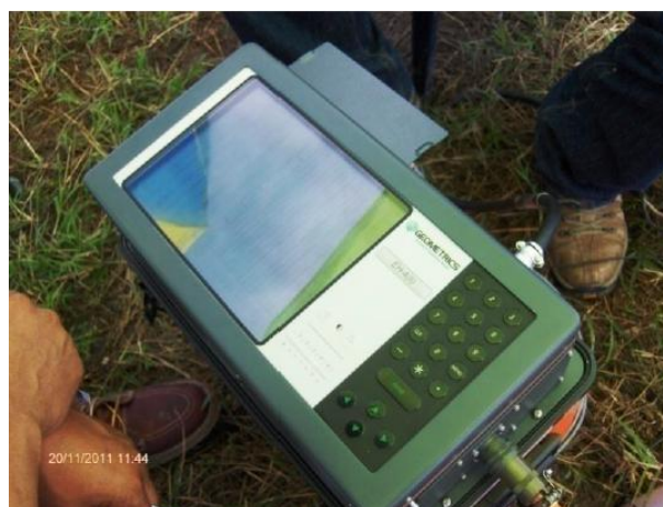
Fig 3.4 Consola STRATAGEM EH4 (Geometrics) [6].
