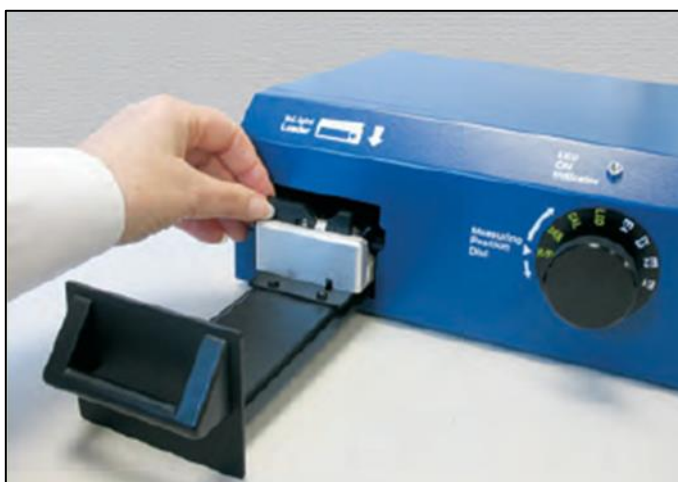
Figura 26. Equipo en donde se lleva a cabo el proceso de evaluación de dosis en los dosímetros. Lector microStar.
