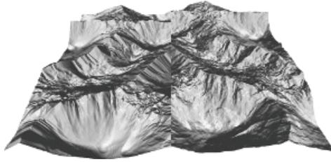
Figura 3.5: Ruido erosivo: original (mitad izquierda) y distorsión del dominio (mitad derecha). Imagen tomada de [5].
