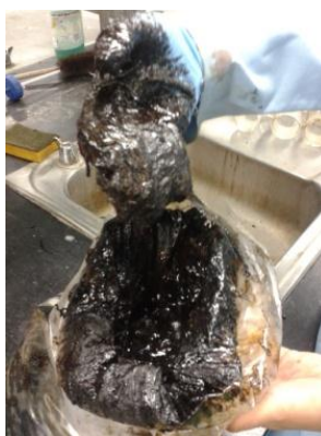
Figura 3.6. Arenas con crudos y otros contaminantes
