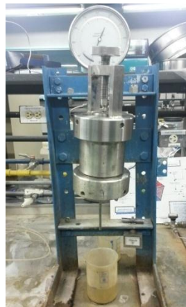
Figura 3.9. Celda de Compactación
