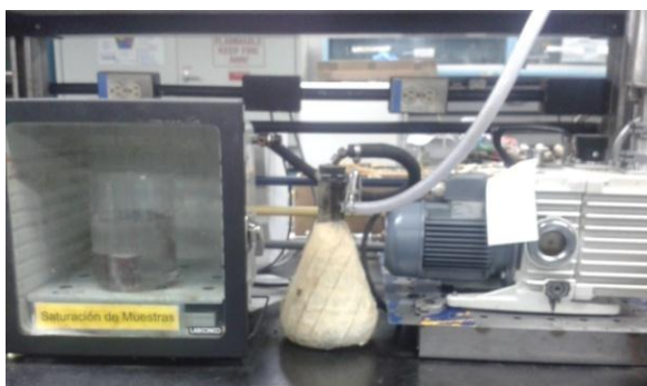
Figura 3.11. Cámara de Vacío
