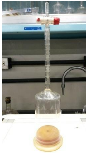
Figura 3.12. Celda de vidrio rotulada usada en los desplazamientos de fluidos espontáneos
