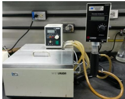
Figura 3.4. Viscosímetro CANNON V-2000 series II y baño térmico asociado
