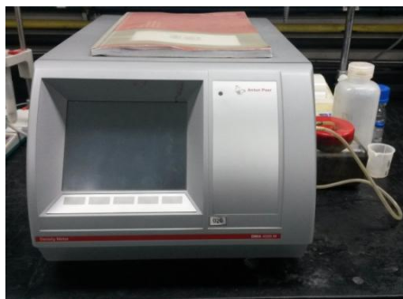
Figura 3.2. Densímetro DMA 4500 MAntonPaar
