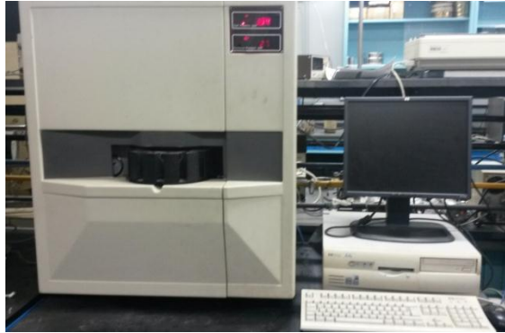
Figura 3.10. CMS (Core Measurement System / Sistema de Medición de Núcleos)
