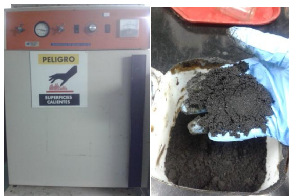
Figura 3.7. Horno y arena impregnada posterior al secado inicial
