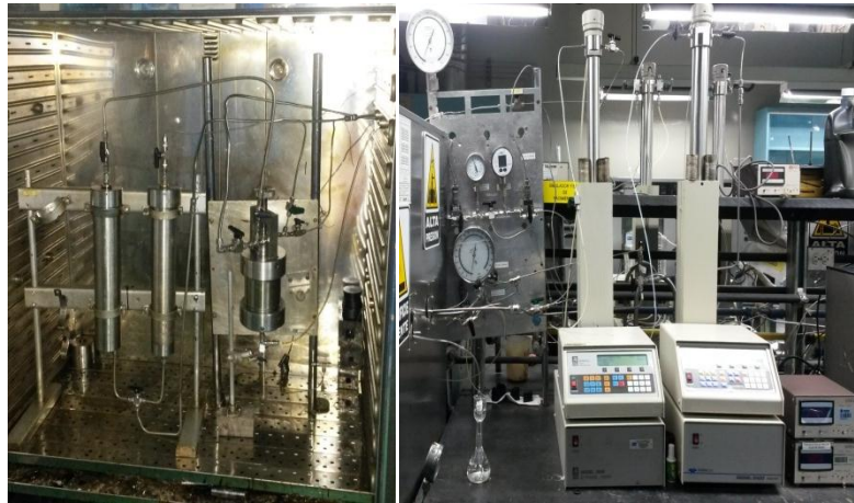
Figura 3.13. Simulador físico de yacimiento
