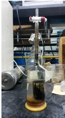
Figura 3.14. Celda de vidrio rotulada durante el proceso de imbibición espontánea
