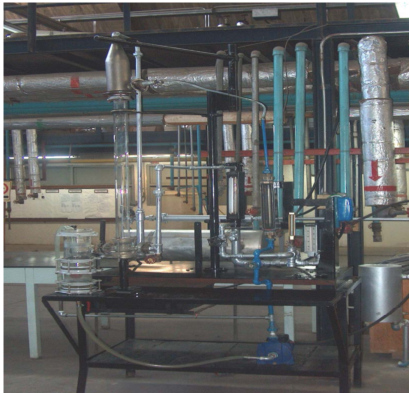
Figura N° 17. Foto de equipo para la determinación de coeficientes de transferencia de masa lado gas.
