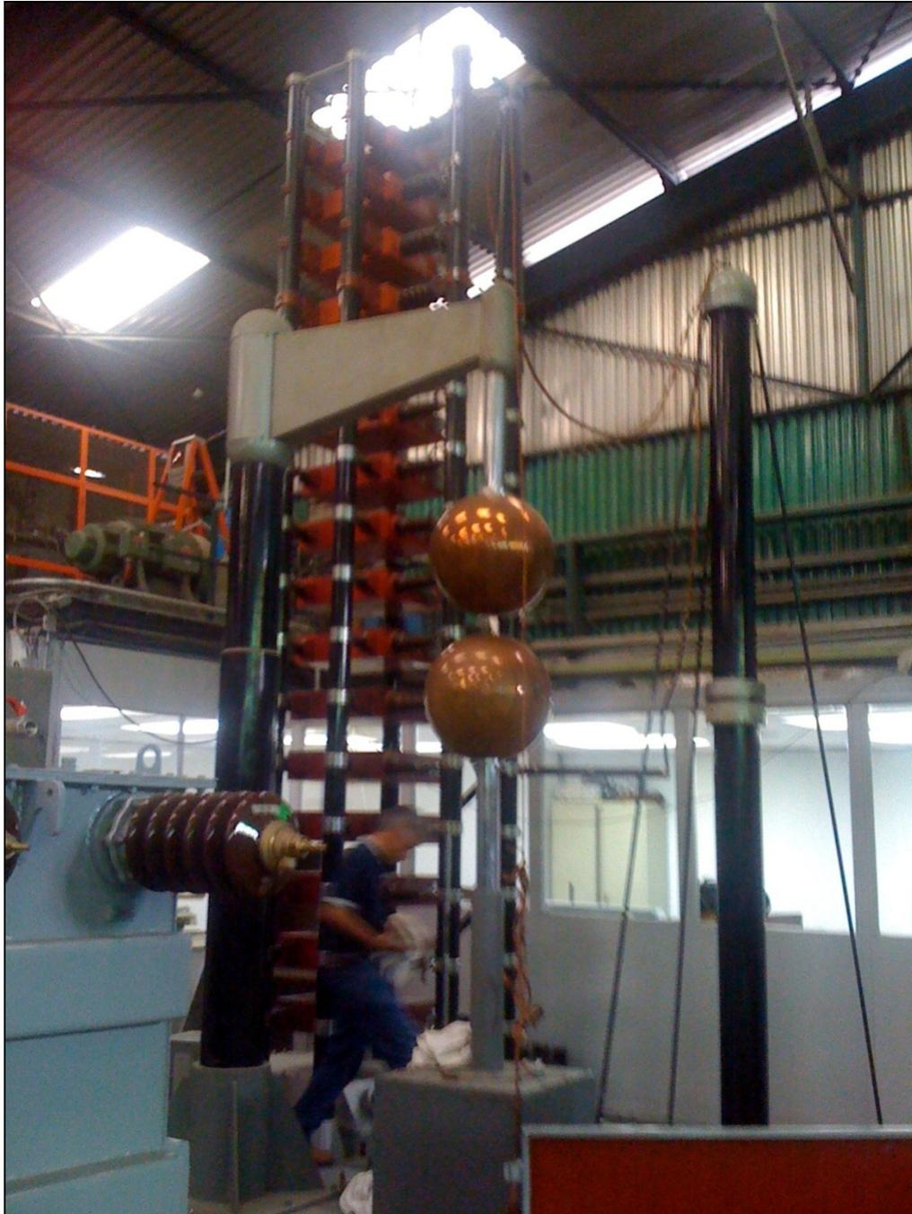
**Figura 31. Generador de Impulsos tipo descargas atmosféricas**
