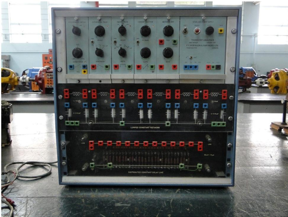
Figura 27. Generador de impulsos y simulador de líneas de transmisión con parámetros concentrados
