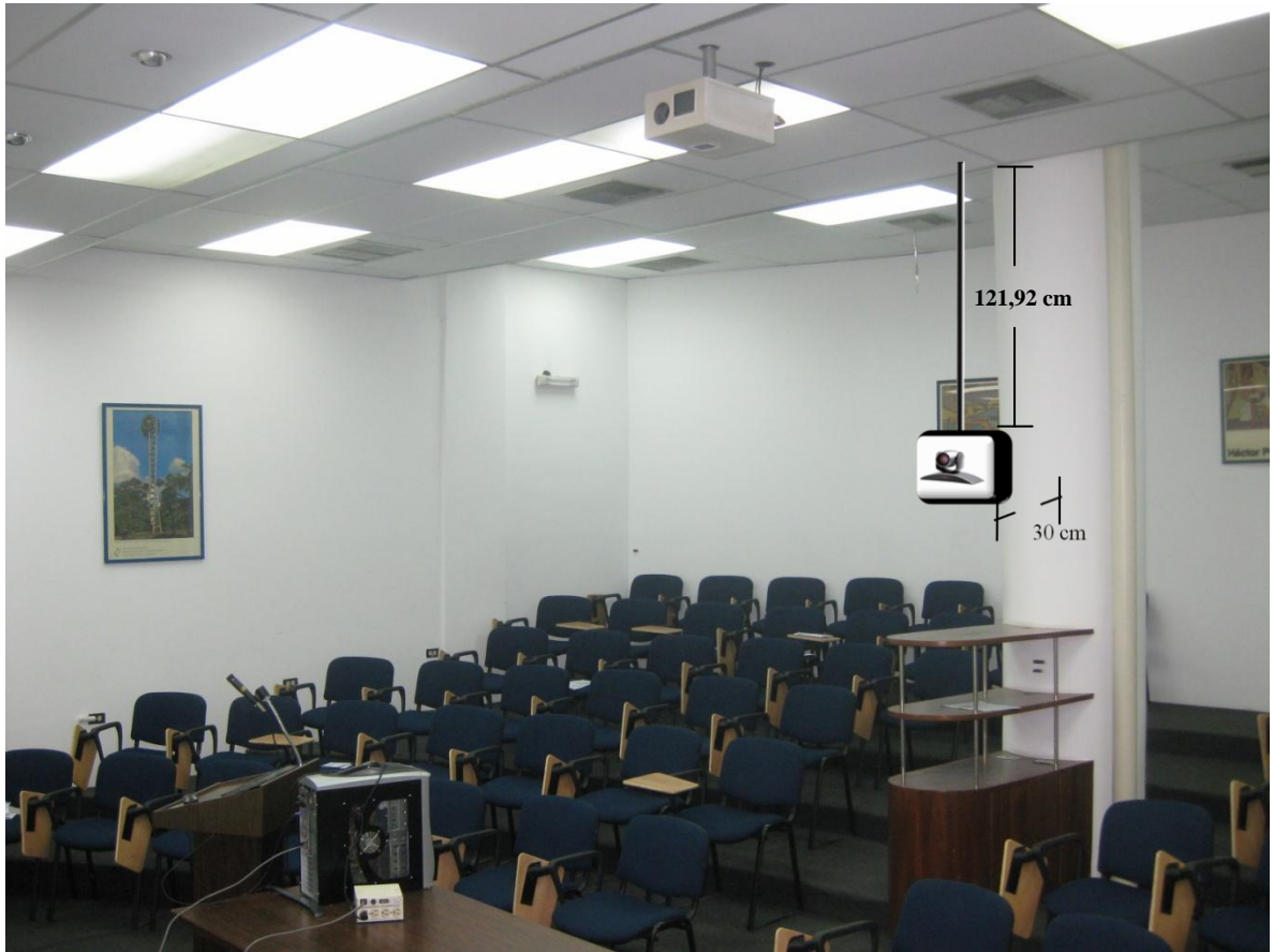
Figura 1. Ubicación cámara principal.
