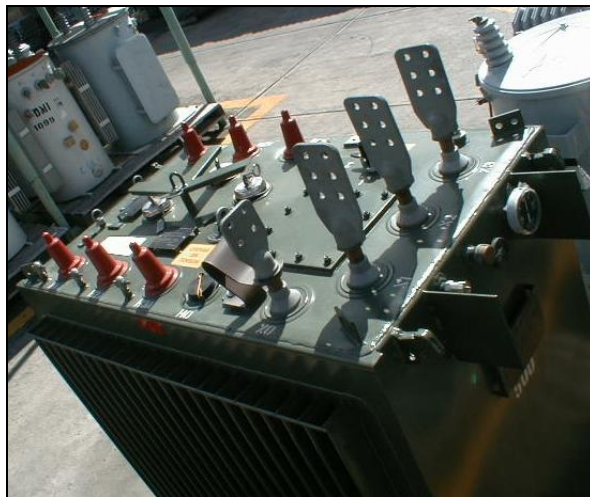
Figura 7. Transformador con protección incorporada, tipo sumergible aislado en aceite
