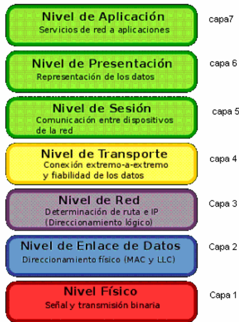
Figura 3. Capas del Modelo OSI. [7]
