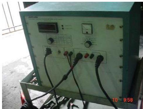
Figura 2.1 Equipo utilizado para la medición de la resistencia de contacto MULTI-AMP-modelo M400C
