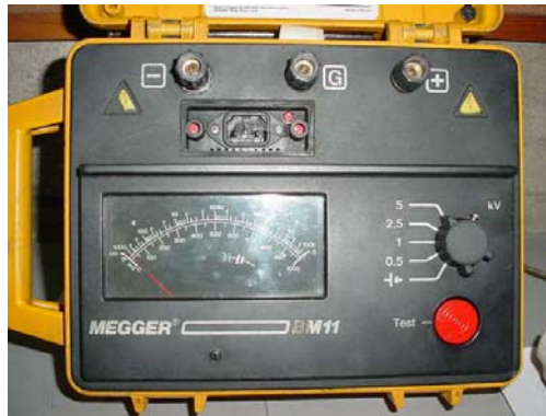
Figura 2.8 Equipo utilizado para la medición de la resistencia de aislamiento.
