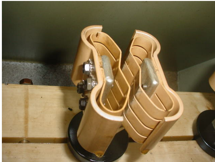
FIGURA 2.12 SISTEMA DE CONTACTO MOVILES
