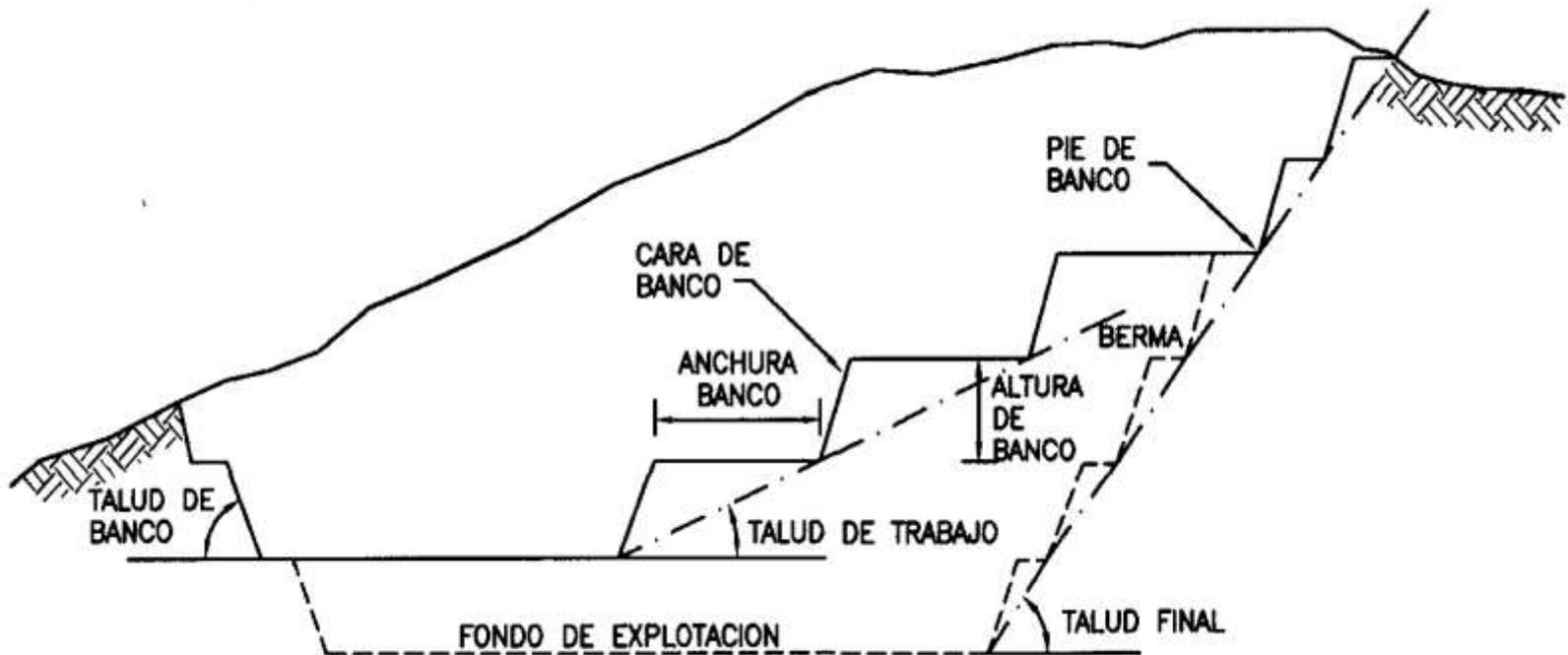
Figura 8.2. Terminología empleada en una mina a cielo abierto.
