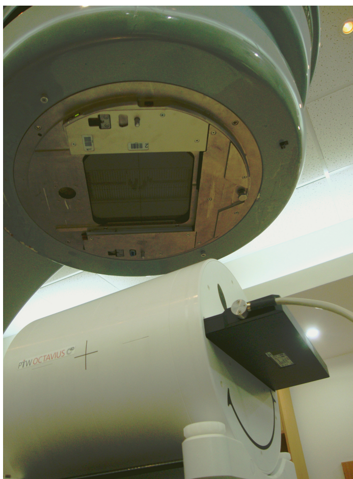
Figura 3.5 – Maniquí contentivo del arreglo de cámaras de ionización, preparado para ser irradiado por el acelerador lineal.
