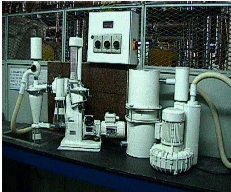
FIGURA N°23. Clasificador centrífugo zigzag.
