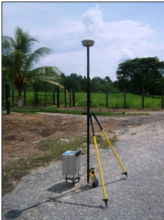
Figura 14. Navegador GPS marca Trimble Geo-Explorer. Bípode para el receptor móvil.
