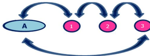
Figura 16. Método de circuito cerrado; en donde A es la estación base en la cual se realiza la apertura - cierre del circuito y 1,2, 3 son estaciones gravimétricas ordinarias.
