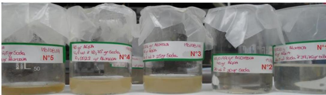
Figura N° 13 Soluciones de aluminato preparadas variando la cantidad de soda caustica.
