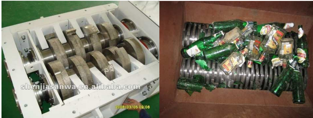
Figura 39a. Martillos de la Trituradora Fuente: Shenjia (2014) www.alibaba.com Figura 39 b. Trituradora en operación Fuente: Idea Holding Limited (2014) http://shreddermachine.in/products.html
