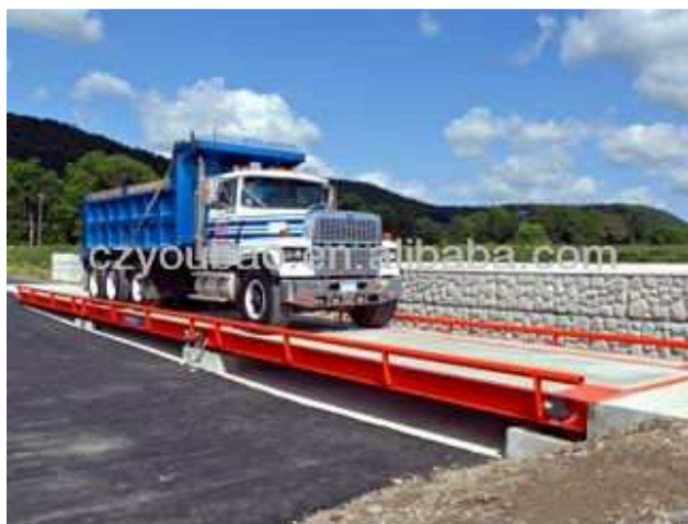
Figura 33. Romana de pesaje en la entrada de la planta.
