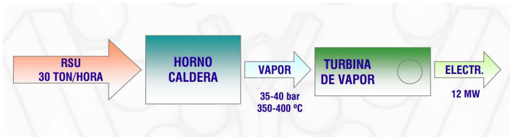
Figura 12. Esquema general convencional de valorización energética de RSU.
