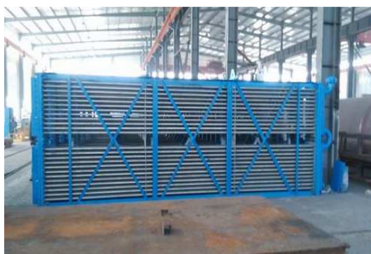
Figura 46. Aerocondensador de Vapor
