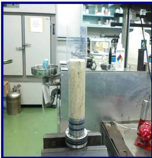
Figura 30. Empacado del núcleo de berea con un cilindro de termo-encogible
