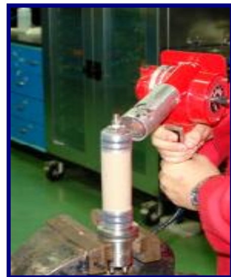
Figura 31. Empacado por ajuste térmico del termo-encogible.
