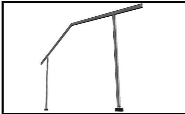
Figura H.1. Pórtico en dirección transversal de las Escuelas Tipo R tradicional.
