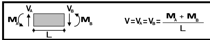
Figura 36. Diagrama de cuerpo libre de una viga eslabón.
