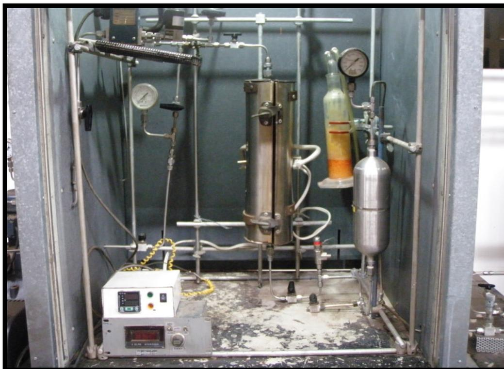
**Figura 9. Equipo para la reacción de Hidrodesclorinación catalítica de Bifenilos Policlorados.**
