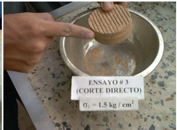
Foto 3.13. Muestra cizallada después del ensayo de Corte.
