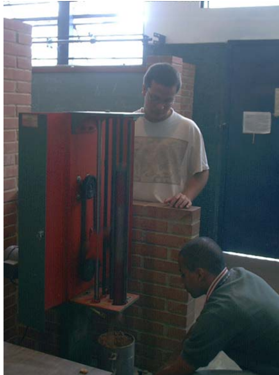
Foto 3.11. Compactación en máquina automática (Ensayo Proctor Modificado).
