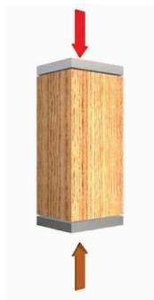
**Figura 3. 5** Esquema de ensayo de compresión paralela (Tomado de CORMA, s.f.)
