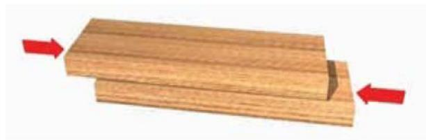
**Figura 3. 12** Esquema de ensayo de corte longitudinal (Tomado de CORMA, s.f.)
