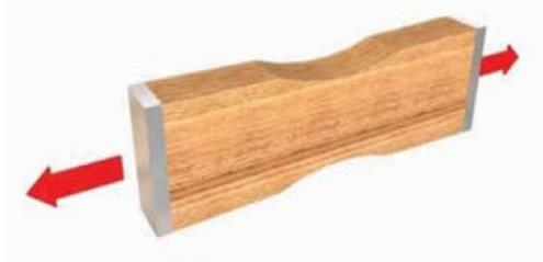
**Figura 3. 7** Esquema de ensayo de tracción paralela a las fibras (Tomado de CORMA, s.f.)
