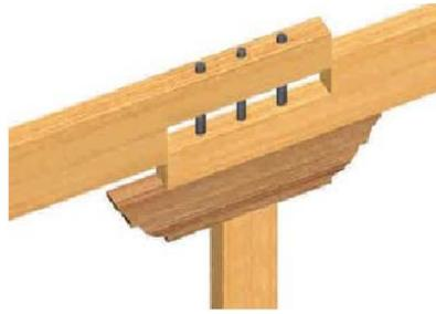
**Figura 2. 7** Necesidad de unir dos vigas en un apoyo (Tomado de CORMA, s.f.)
