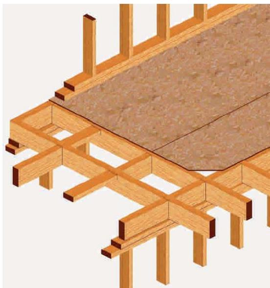
**Figura 2. 15** Entramado horizontal (Tomado de CORMA, s.f.)
