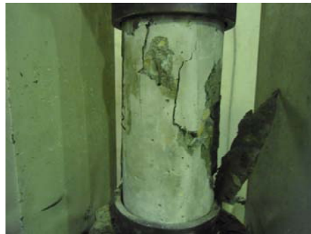
Anexo 10. Falla del cilindro 1 de la mezcla EE7.
