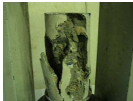
Anexo 12. Falla del cilindro 1 de la mezcla EE28.
