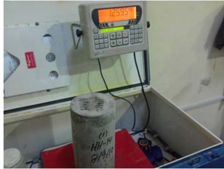
Fig. 13. Pesaje de las probetas en estado endurecido.
