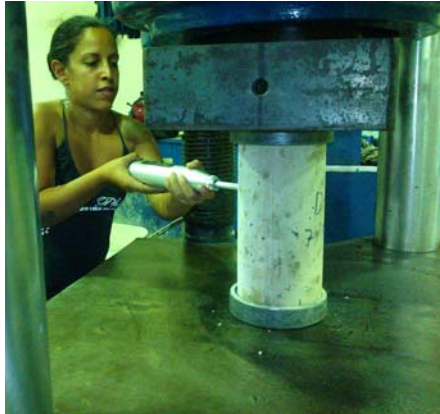
Fig. 15. Medición de la Esclerometría en los cilindros.
