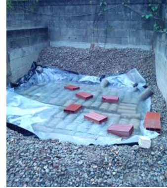
Fig. 9. Piscina con adición de cal para curado de probetas.
