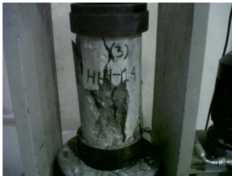
Anexo 21. Falla del cilindro 3 de la mezcla HH14.
