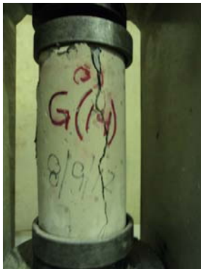
Anexo 17. Falla del cilindro 3 de la mezcla G14.
