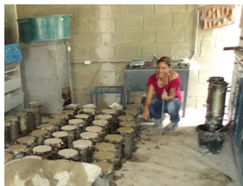
Fig. 7. Enrazado de probetas estandarizadas.
