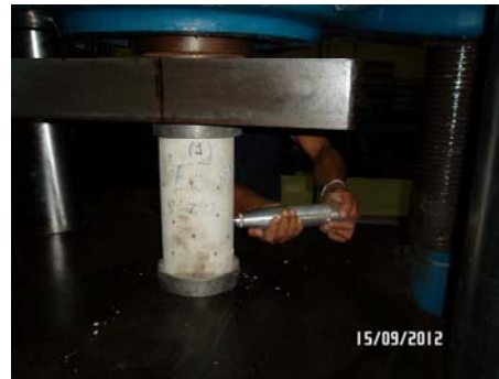
Anexo 8. Ensayo de esclerométrico.
