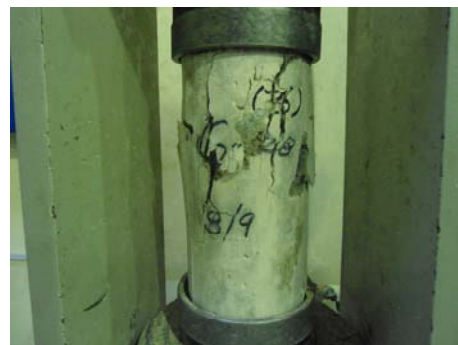
Anexo 18. Falla del cilindro 3 de la mezcla G28.
