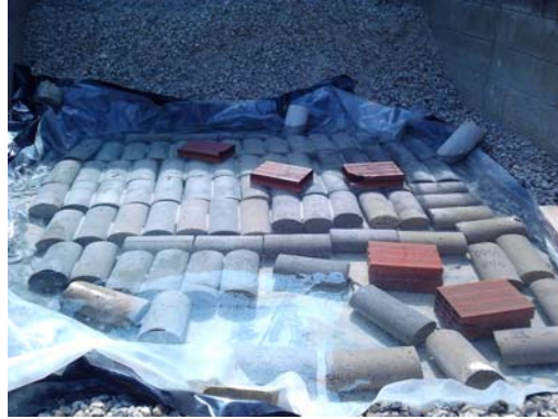
Fig. 8. Piscina con adición de cal para curado de probetas.
