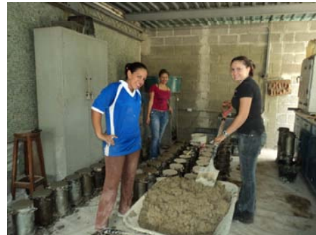
Anexo 3. Vaciado y enrasado de probetas.
