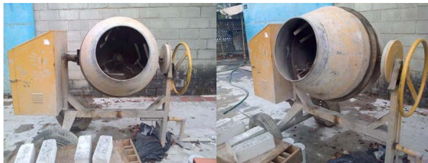
Fig. 5. Mezcladora de concreto, 110 L de capacidad.
