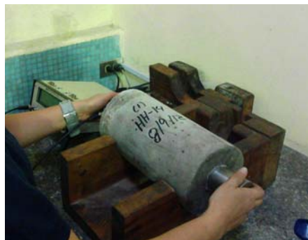
Fig. 14. Medición del pulso ultrasónico en los cilindros.
