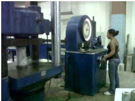
Anexo 7. Uso de la prensa para los ensayos esclerométrico.
