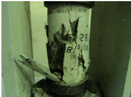
Anexo 15. Falla del cilindro 2 de la mezcla FF28.
