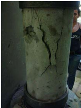
Anexo 9. Falla del cilindro 3 de la mezcla E7.
