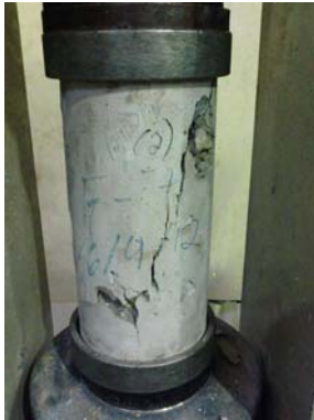
Anexo 13. Falla del cilindro 2 de la mezcla F7.
