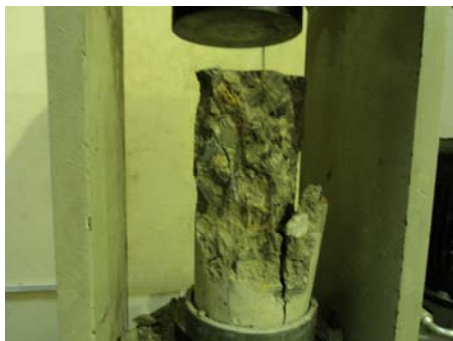
Anexo 11. Falla del cilindro 1 de la mezcla EE14.
