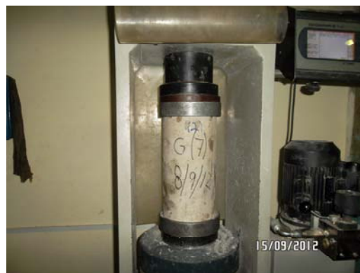
Fig. 16. Ensayo de compresión a los cilindros de concreto.
