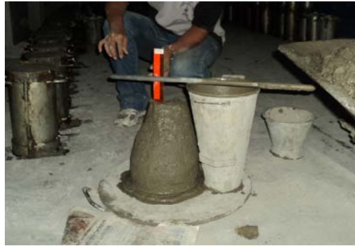
Fig. 10. Medición del asentamiento con el cono de Abrams.
