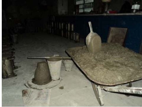
Anexo 1. Ensayo de cono de Abrams.
