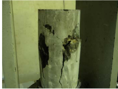
Anexo 20. Falla del cilindro 2 de la mezcla H14.
