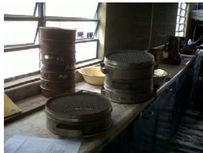
Fig. 3. Tamizado para el agregado grueso.
