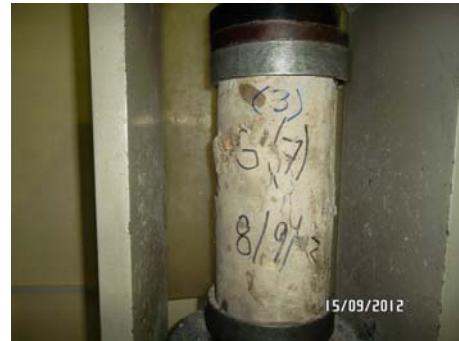
Anexo 16. Falla del cilindro 3 de la mezcla G7.
