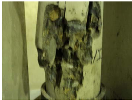
Anexo 22. Falla del cilindro 1 de la mezcla HH28.
