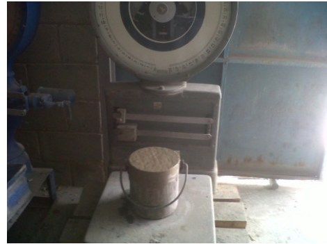
Fig. 12. Pesaje de la tara normalizada más el concreto en estado fresco.
