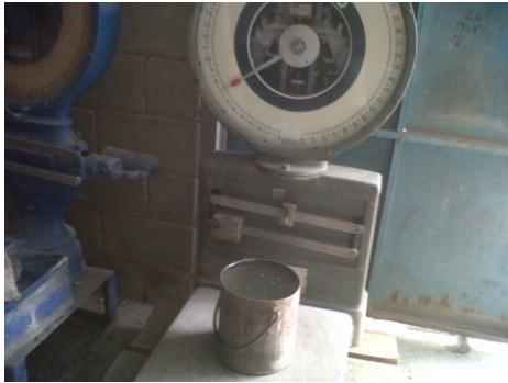
Fig. 11. Pesaje de la tara normalizada.
