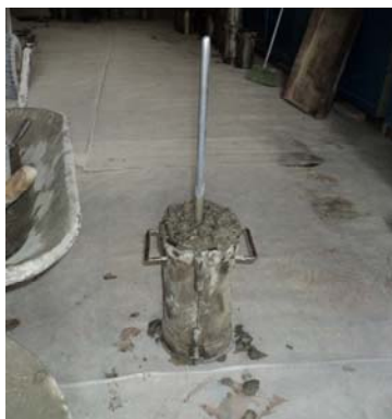
Fig. 6. Compactación de la mezcla en cilindros normalizados.
