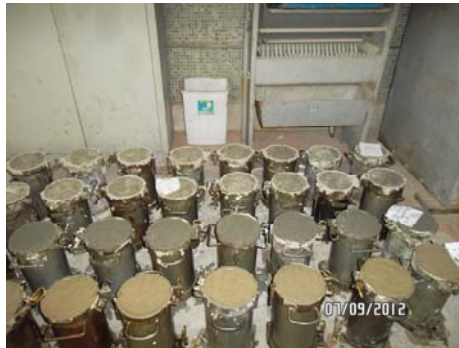
Anexo 4. Probetas en proceso de fraguado.
