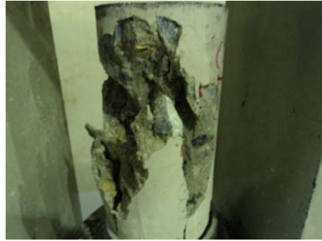
Anexo 14. Falla del cilindro 3 de la mezcla FF14.
