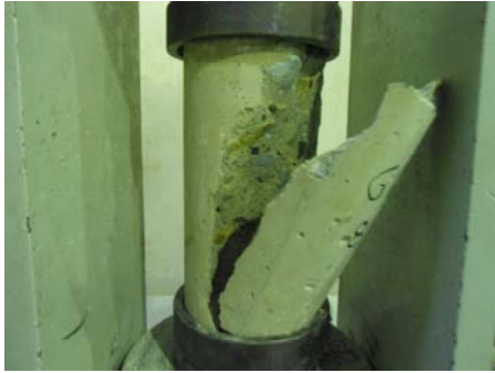
Anexo 19. Falla del cilindro 1 de la mezcla GG7.
