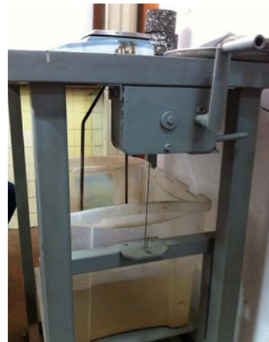
Fig. 3.4 Peso específico. Agregado grueso
