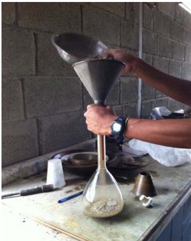
Fig. 3.3 Peso específico. Agregado fino
