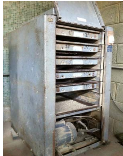
Fig. 3.2 Tamizado. Agregado grueso
