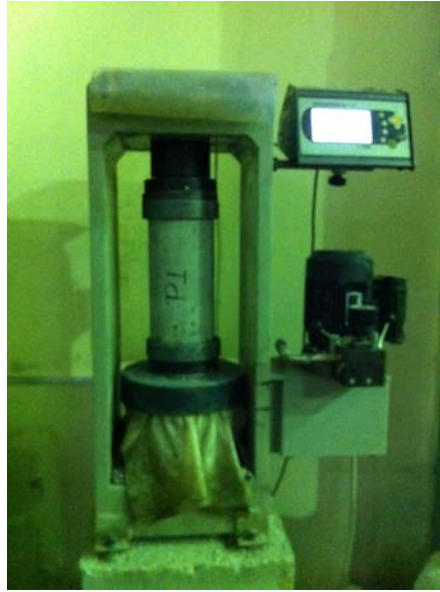
Fig. 3.8 Ensayo de resistencia a compresión
