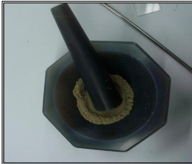
Figura 39. Pulverizado y homogenizado de las muestras.
