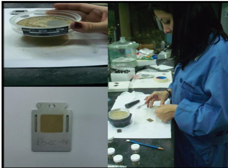
Figura 41. Tratamiento de la muestra y montaje para el análisis de Difracción de Rayos-X
